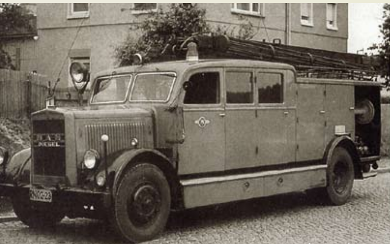
MAN mudel D1 alusel 1936.a. firmas Fischer valmistatud tuletõrje autopritts (põhiauto) KS 25
