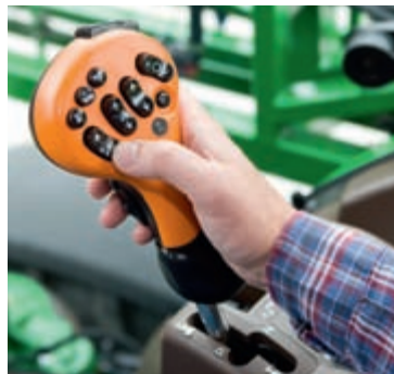
Nii nagu kombaini, käib ka pritsi liikumiskiiruse muutmine, poomi liigutamine ja pihustite juhtimine ühe juhtheebliga.
