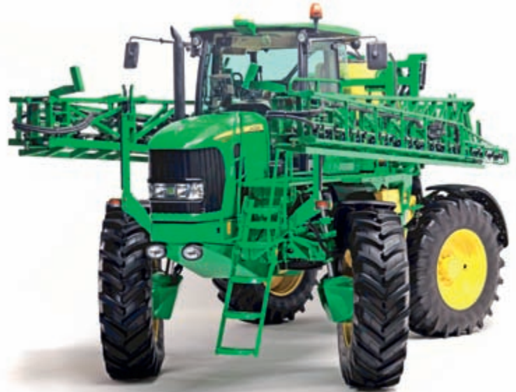
John Deere'i iseliikuv prits on sileda põhjaga, transpordil kiire ja kompaktne ning nelja ratta roolimisega. Standardratastega on kliirens 1,2 m.
