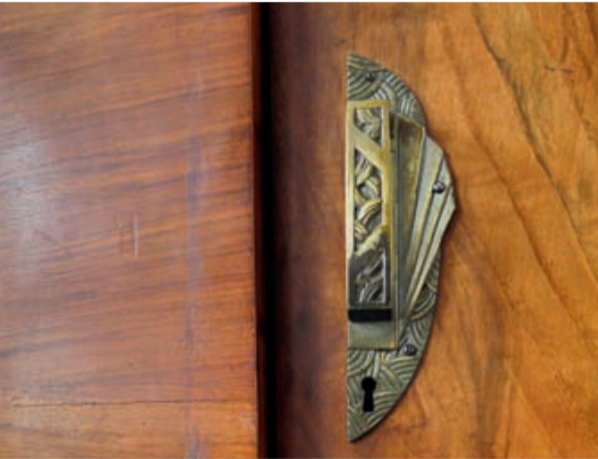
Riidekapil on põnevad metallist käepidemed. Metallosad võib 00-villaga läikima hõõruda. Mina jätan käepidemed lihvimata.
