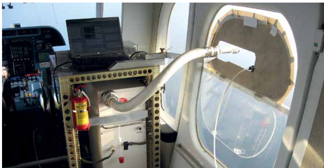
NAIS kogub teavet tsepeliini aknast ning salvestab kogu saadud info. Kõik õhulaevas olevad suuremad mõõteaparatuurid on paremaks transportimiseks pandud tugevasse metallraami.
