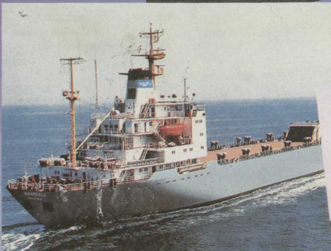
" Haapsalu " Ro-Ro- tüüpi laev. ( Ro-Ro- roll on, roll off - mõlemast otsast laadimist võimaldavad.) Seda tüüpi laevad veavad sõidukeid, järelveokeid ja külmutusseadmeid sisaldavaid konteinereid.
