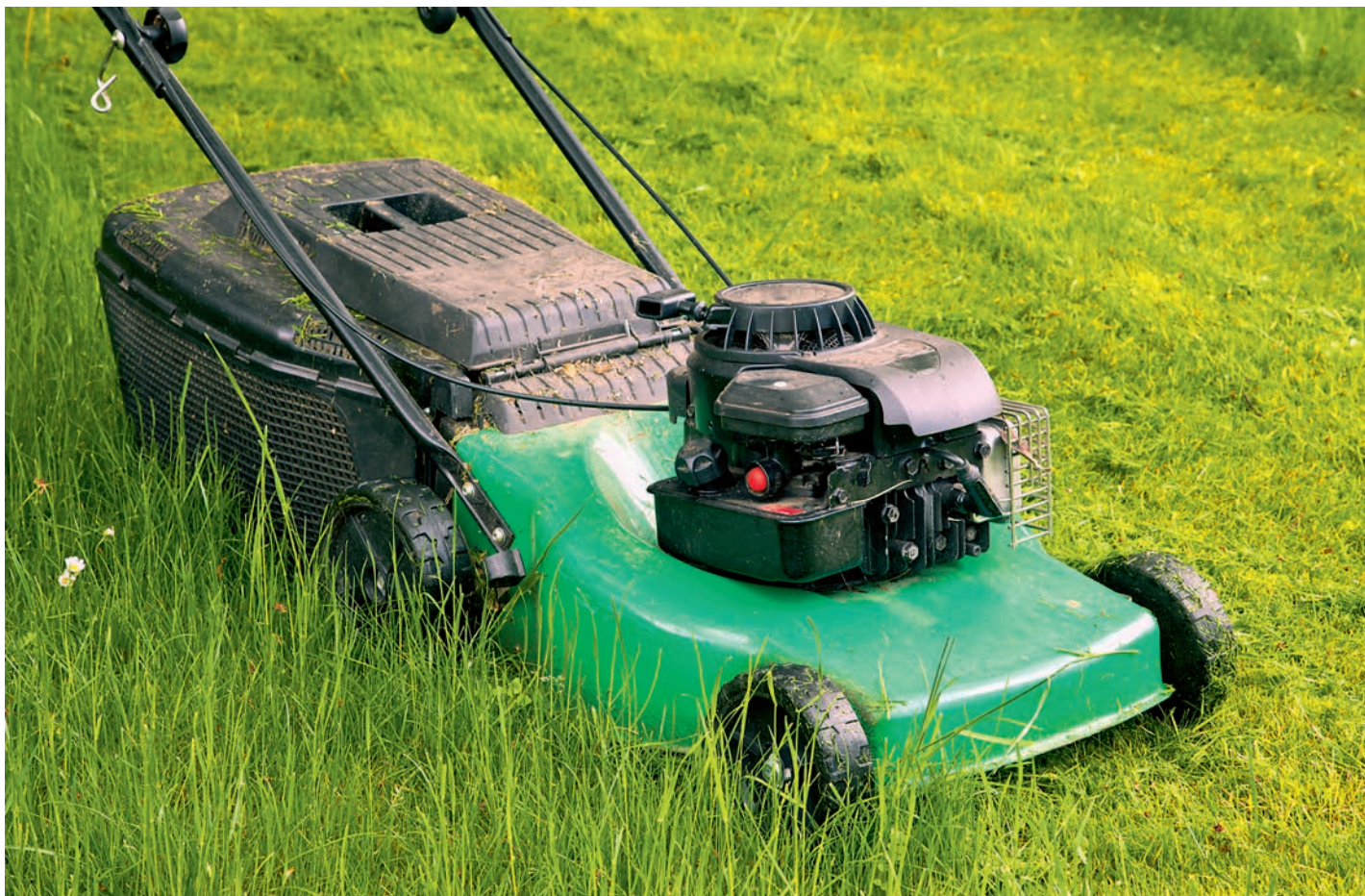
Niiduk vajab pidevat hoolt ja puhastamist. Kord aastas tuleb aga õli vahetada.
