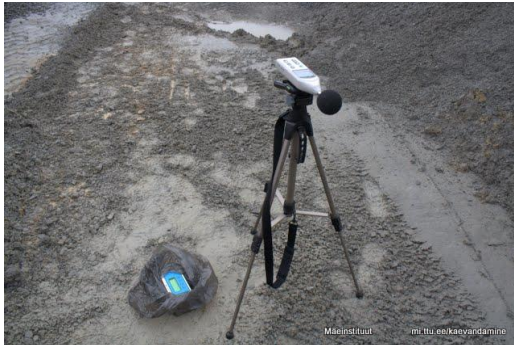
Joonis 43 Purustite vibratsiooni ja dolokivi raimatavuse mõõtmine
