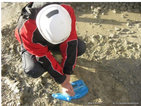
Joonis 55 Vibratsiooni mõõtmine seismomeetriga
