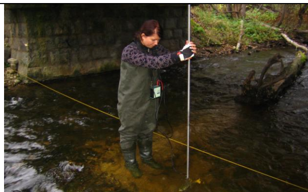
Joonis 96 Vooluhulga määramine Toolse jões kaasaegse tiivikuga Universal Current Meter F1
