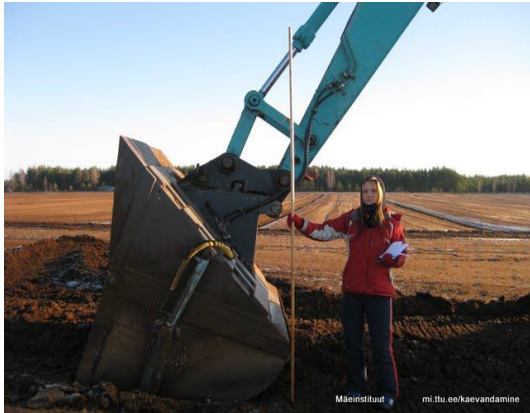
Joonis 38 Masinate parameetrite mõõtmine, alltühjendatava pärikopaga laadimisekskavaator
