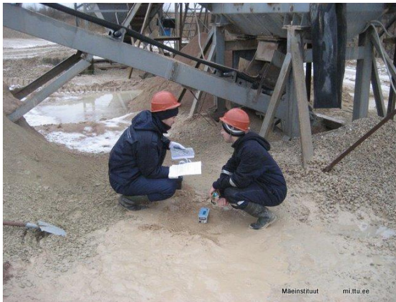
Joonis 33 Purusti vibratsiooni mõõtmine
