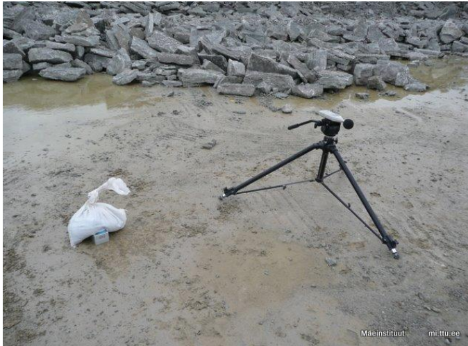
Joonis 23 Vibratsiooni ja mürataseme mõõtmine
