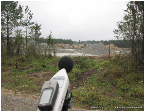
Joonis 42 Karjääri mürataseme mõõtmine
