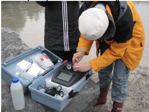
Joonis 45 Settebasseini vee olukorra analüüsimine
