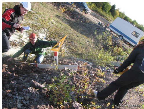
Joonis 57 Karjääri elementide - astangute, rampide, puistangute mõõtmine laserite, nurgamõõtjate ja GPS-dega
