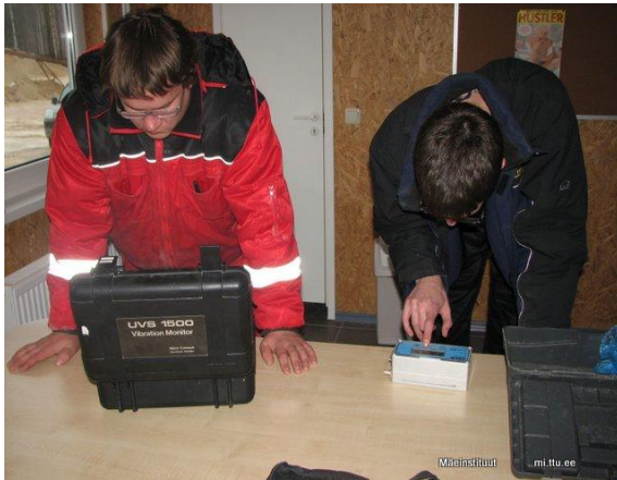
Joonis 32 Vibratsiooni mõõtmisseadmete sünkroniseerimine
