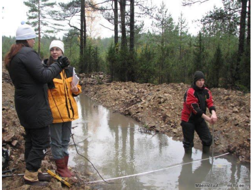
Joonis 44 Väljapumbatava vee vooluhulkade määramine äravoolukraavis
