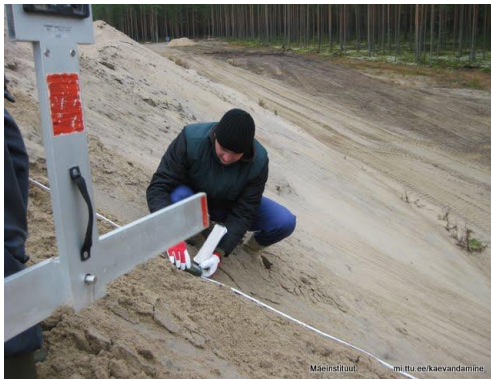
Joonis 52 Settekaardi nõlva pikkuse ja varingukaldenurga mõõtmine
