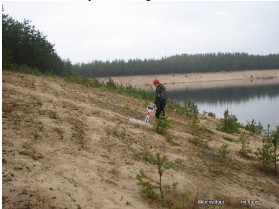
Joonis 27 Karjääri nõlva varingukaldenurga mõõtmine
