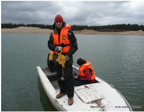
Joonis 53 Karjääri põhja ja nõlva mõõtmine
