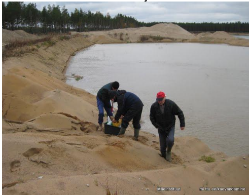
Joonis 51 Proovide võtmine Kiiu Soone liivakarjääris
