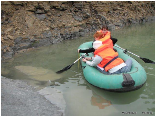
Joonis 46 Mõõdistamistöid settebasseini läbilõikete koostamiseks
