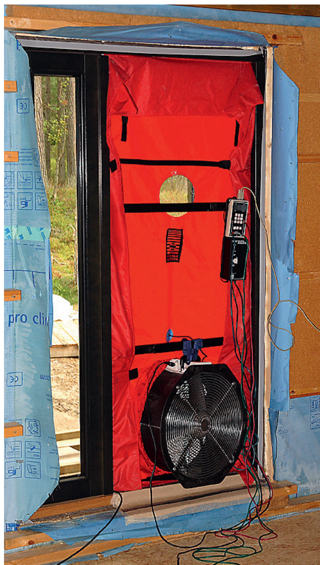
ÜLERÕHUTESTIS kasutatakse udugeneraatorit, mis toodab hoone sisemusse suitsu. Seejärel tekitatakse hoonesse ülerõhk, mis surub hoone sees oleva suitsu läbi välispiirde, muutes lekked kergesti leitavaks.
