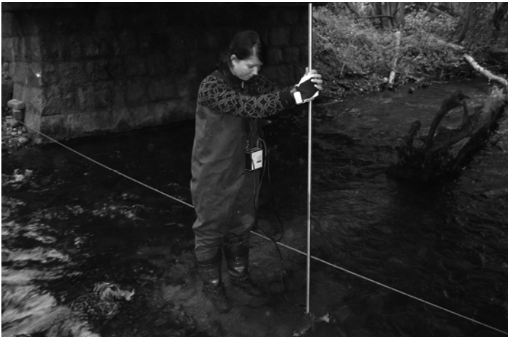
Joonis 8. Vooluhulga määramine Toolse jões kaasaegse tiivikuga Universal Current Meter F1.
