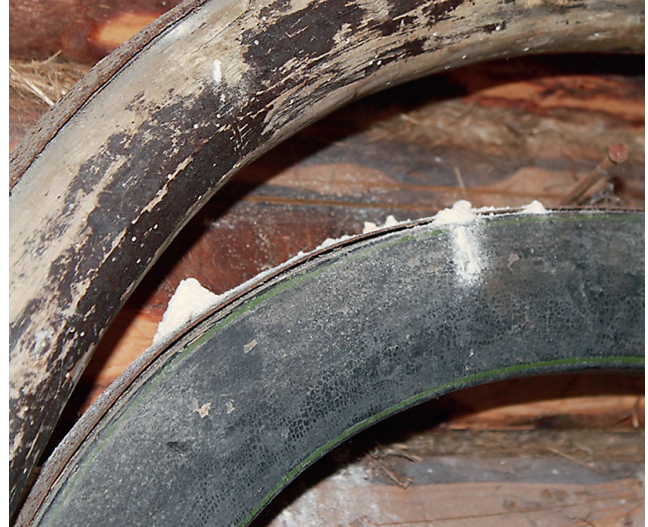
TOONESEPLASTE , täpsemalt mööbli-toonesepa ( Anobium punctatum ) tekitatud väljalennuavad ja näripuru hunnikud.
