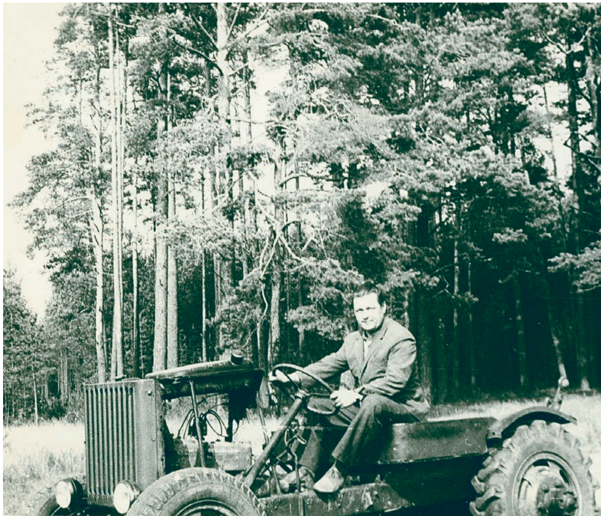
Raivo Ojaperve valmistatud traktor oli tehtud GAZ-AA baasil.
