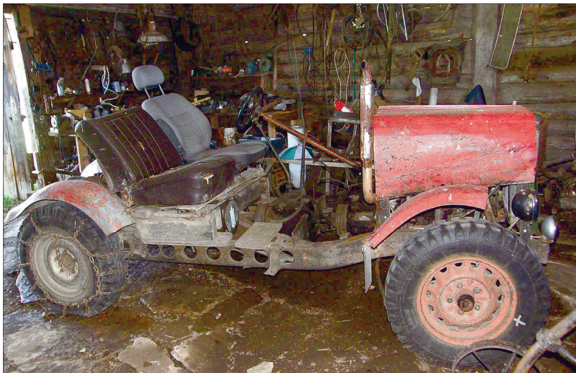
Enno Kasearu tehtud traktoril kasutati Moskviitši mootorit.
