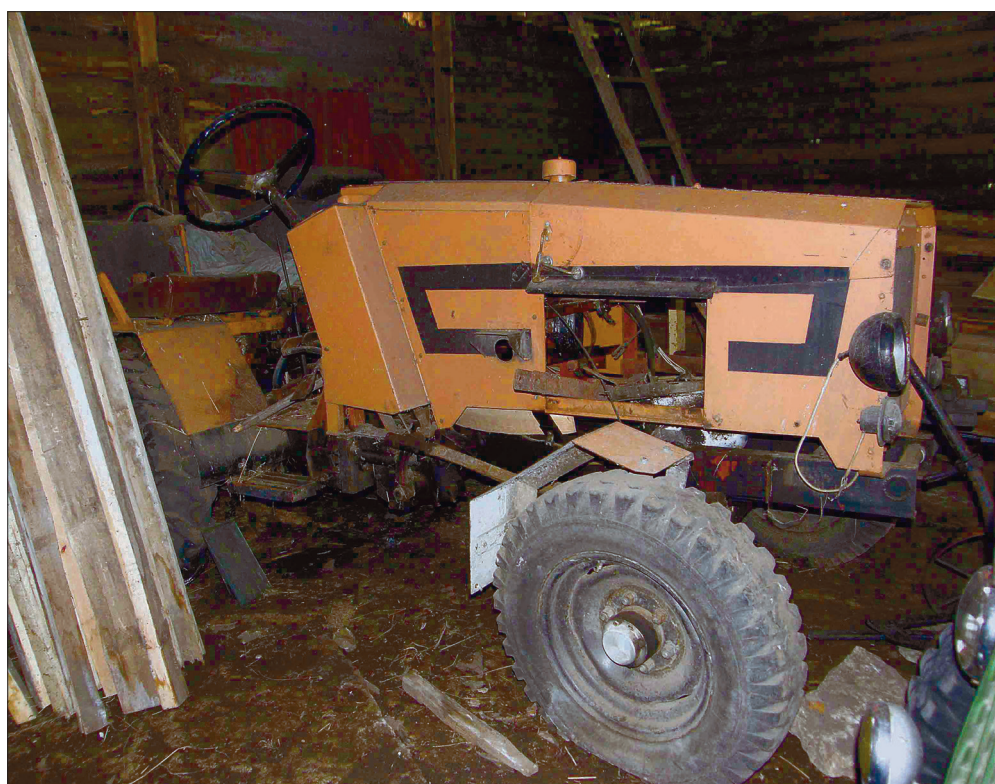
Enno Kasearu tehtud traktoril kasutati Moskviitši mootorit.
