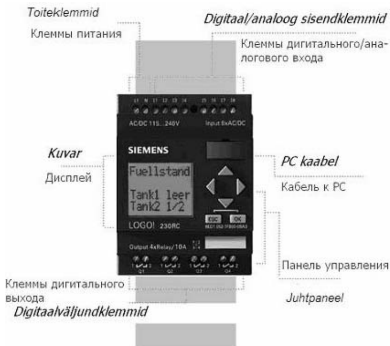
Joonis 1.3.4. Kontrolleri üldvaade.
