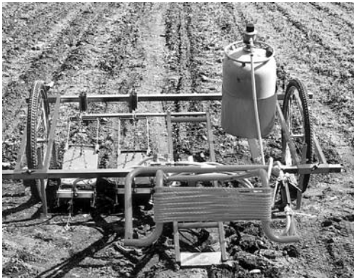
Kergele raamile ehitatud leegitusagregaat (vasakul, foto: M. Mikk); Skemaatiline plaan leegitamise aja valikuks (paremal)
