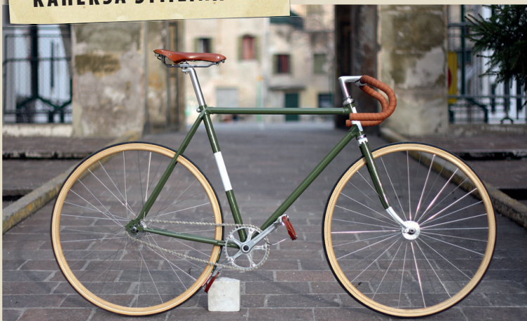
OLIVA – BIASCAGNE CICLI Käiguvahetuseta, terasraamiga, puidust pedaalide ning Brooks'i sadula ja lenkstangiga mudel. ( biascagne-cicli.it )
