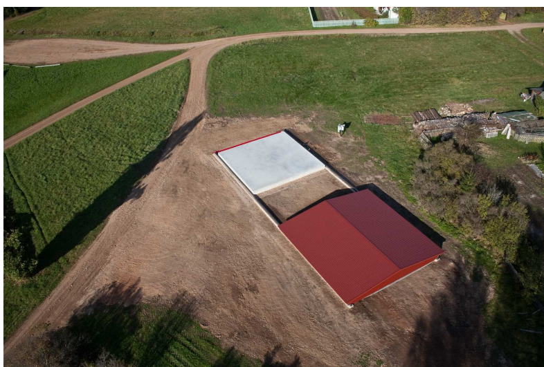
Pegeldusetalon Järveljal. A reflection etalon at the Järvelja test site.
