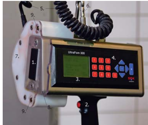
Joonis 11. UltraFom 300 koos märgistuseseadmega (1. – mõõteandur, 2. – lülitiga käepide, 3. – vedelkristallekraan, 4. – klaviatuur, 5. – ühendusjuhtmed, 6. – riputusaas, 7. – märgistuseseade, 8. – juhtplaat, 9. – värvidüüsid)
