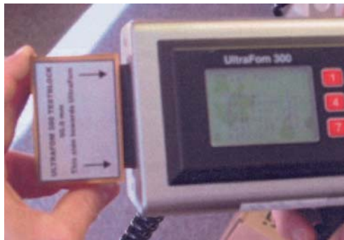
Joonis 17. UltraFom 300 mõõtmistäpsuse kontrollimine /pilt: "SFK Technologies"
