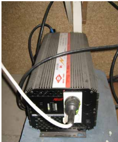
Joonis 6. Autodel kasutatav inverter võimsusega 3000 W, mis muundab alalisvoolu vahelduvvooluks Figure 6. Car inverter 3000 W
