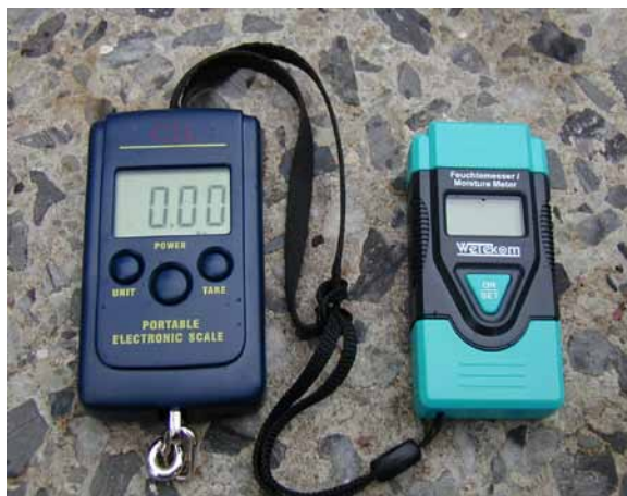
Joonis 2. Puidu massi saab määrata rippkaaluga ja niiskust elektrijuhtivuse kaudu
