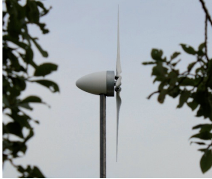
Joonis 6. Allatuult elektrituuliku prototüüp Figure 6. Prototyp downwind windmill
