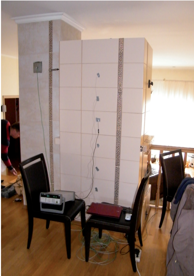
Joonis 2. Moodulahju pinnatemperatuuride mõõtmise üldvaade. Pinnaandurite järjekord alt lugedes on 2-4-5-7-3-8-6.
