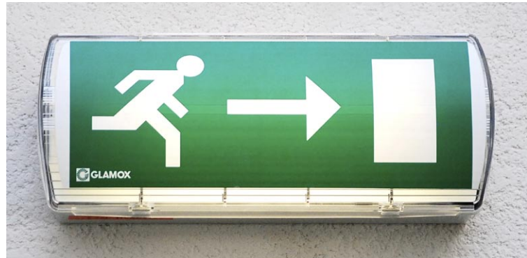
Eestis on turvalgustuseks haiglates ja hooldekodudes enim kasutusel 8W päevavalgustoruga, sisseehitatud akuga ja vastava kleebisega evakuaatsiooni-valgustid ehk sisevalgustusega evakuaatsioonimärgid
