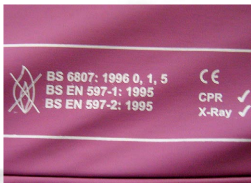
Viited süttimiskindluse standarditele madratsil Birminghami lastehaiglas
