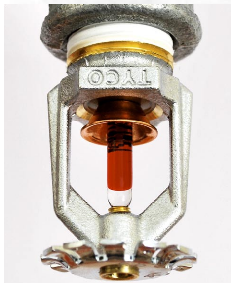
Kuumuse toimel puruneb sprinkleri klaas-ampull, eemaldub kork düüsilt ning sprinkler hakkab vett pritsima. Toodetakse erineva reageerimiskiirusega sprinkleripäid, samuti erinevaid päid monteerimiseks nii seinale kui lakke
