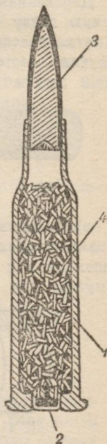
Рис. 44. Боевой патрон: 1—гильза, 2—капсюль, 3—пуля, 4—порох
