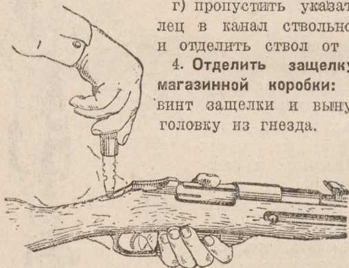
Рис. 53. Вывинчивание хвостового винта
