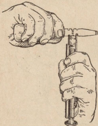
Рис. 51. Проверка выхода бойка ударника
