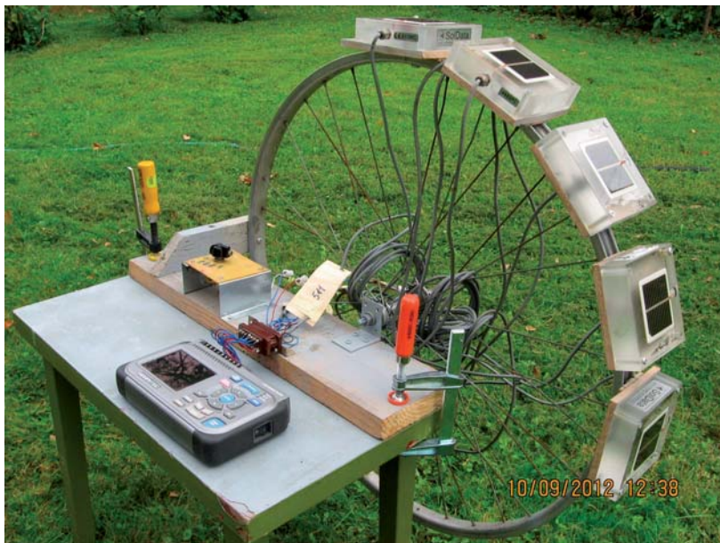
Joonis 7. (Haju)kiirguse kaldpindadel mõõtmise stand Figure 7. Measuring device used
