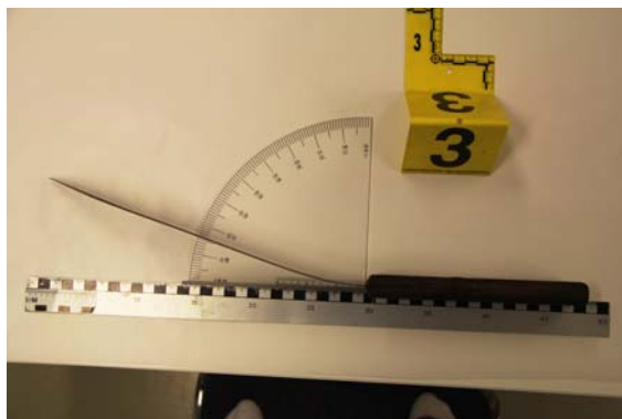
Foto 25. Näide löökide käigus paindunud noa paindenurga dokumenteerimisest
