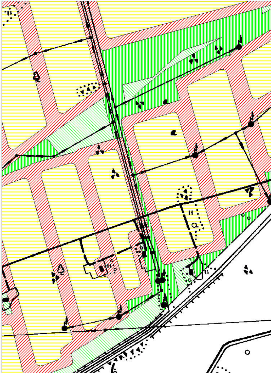
Joonis 7. Maa oleku plaan Kohtla kaevanduse lõunaosas. Püsiv maa väljamata jäänud karstitsoonide ja hoonete alla jäetud tervikute kohal on tähistatud helerohelise viirutusega. Stabiilne on maa kambritega väljatud ala kambriplokkide vaheliste käikude kohal ja on viirutatud tumeroheliseks. Kvaasistabiilne maa, mis plaanil on punasetriibuline, moodustus langetatud alade piirimaile. Kollasetriibuline on langetatud maa – vajumislohkude põhi. Plaanil on mustaga joonistatud teed (pidev joon), elektriliinid ja nende postid (peen joon nooltega), hooned, varemed, aiamaad. Plaani alumisse ossa tõmmatud paarisjoon tähistab kaevandusvälja lõunapiiril olevat magistraalkraavi.
