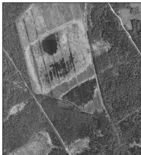
Joonis 6. Tüüpiline kvaasistabiilne ala Estonia kaevanduse peal. Sellist situatsiooni Kohtla peal ei ole ega teki.
