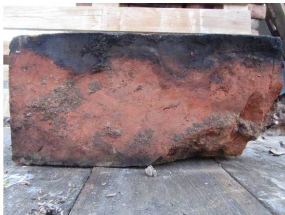
Joonis 10.1 Ahjupoti (vasakul) ja ahjukivi (paremal) otsapind reedab, et kividevaheline vuuk ei ole terviklik: ajapikku on müürimört ära lagununud.
