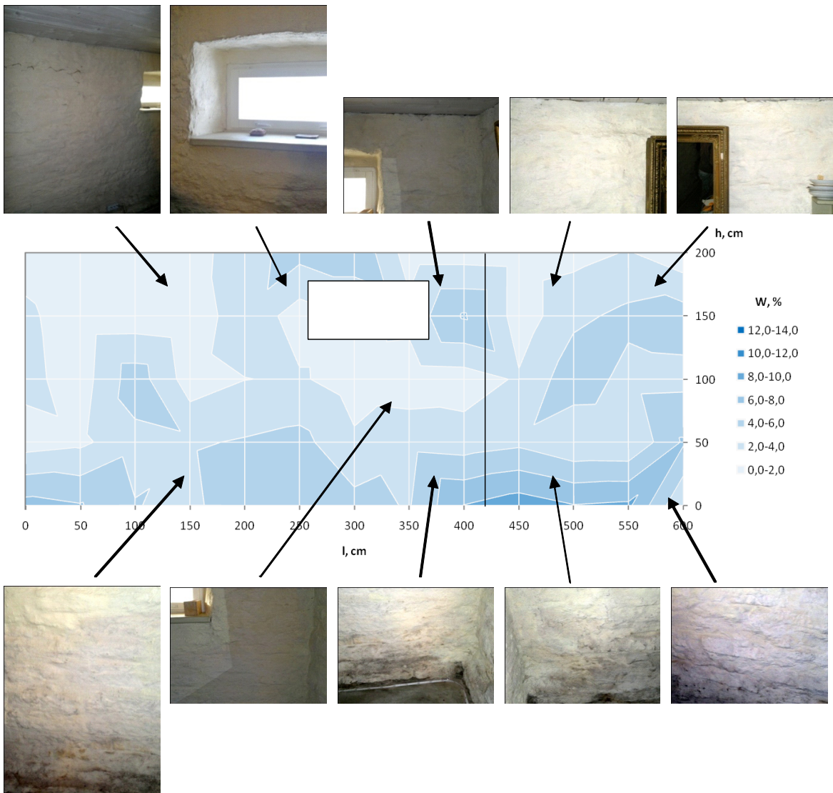
Joonis 2.53 Eluruumidena kasutatava köetava keldri seinte niiskusesisalduse kaart sügavuseni kuni 30 cm.
