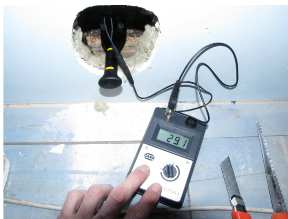
Joonis 5.26 1,5 aastat pärast seespoolse lisasoojustuse paigaldamist oli palgi niiskus väga suur: ~30 %.
