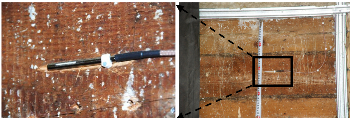
Joonis 5.5 Suhtelise niiskuse ja temperatuuri anduri paiknemine palkseina sisepinnal.
