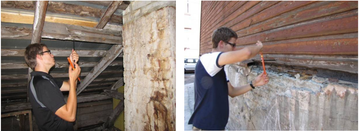
Joonis 2.3 Puurproovide võtmine katusekonstruktsioonist ja välisseina alumistest palkidest.
