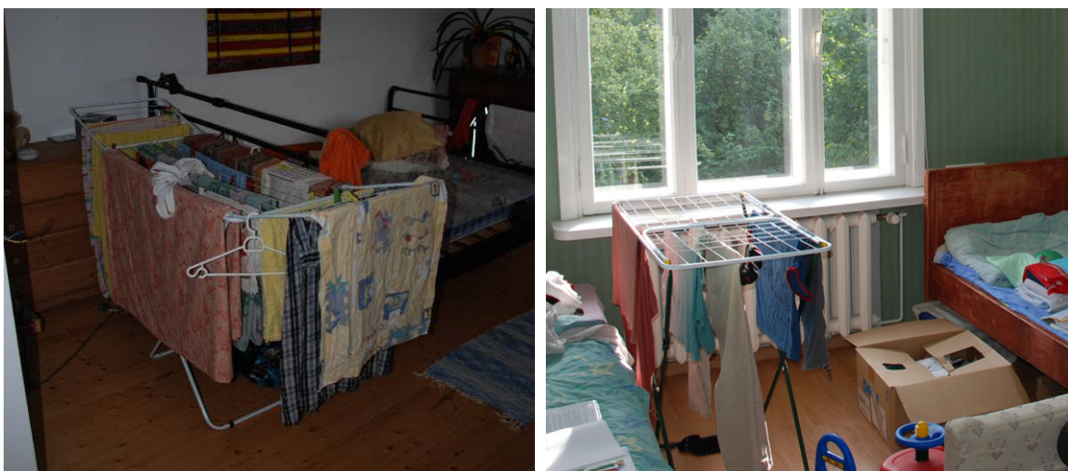
Joonis 7.21 Pesukuivatust siseruumides puuduliku ventilatsiooni tingimustes tuleb pidada lubamatuks.
