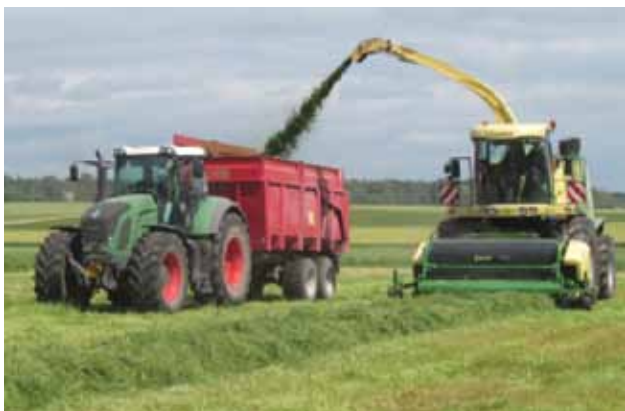
Joonis 8.7. Liikurhekseldiga haljasmassi vaalust kogumine ja haagisele hekseldamine (Vettik, R.)
