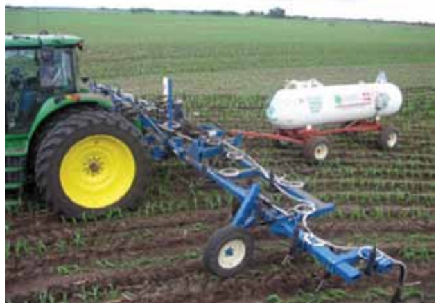
Joonis 3.14. Ammoniaagiväeturi ja selle haakes ammoniaagipaaki (AgSystems, 2011)
