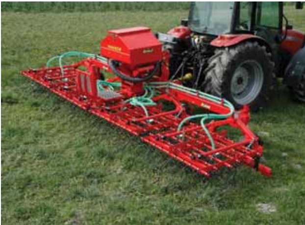
Joonis 8.1. Ristikut saab allakülvata taliteravilja kevadisel äestamisel ökoakkele paigaldatud külviseadmega (Einböck, 2013)
