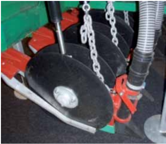
Joonis 5.18. 2-kettaline avalõhe-sisestusseadis (Vettik, R.)
