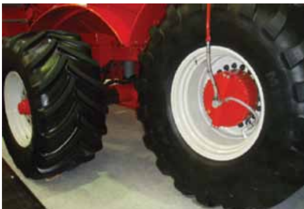
Joonis 5.42. Muudetav rööbe ja rehvirõhu muutmise süsteem (Vettik, R.)
