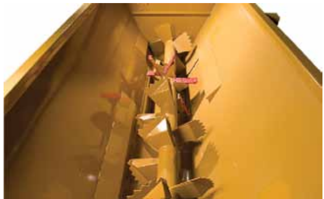
Joonis 6.4. Mahuti ülemine serv on sissepoole pööratud et vähendada vedela materjali üle serva loksumise võimalust (Richard Western, 2012)
