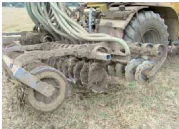
Joonis 5.16. Vedelsõnniku ketassõbastusseadis (Tamm, K.)
