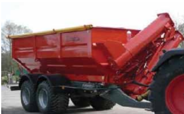
Joonis 2.5. Tigukonveieritega transpordi-laadimiskäru (Konekesko, 2012)
