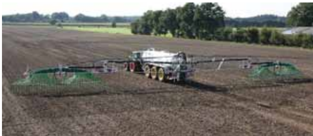
Joonis 5.46. Laotamispuumi asendi muutmisevõimalusega lohistaotur (Vogelsang, 2012b)
