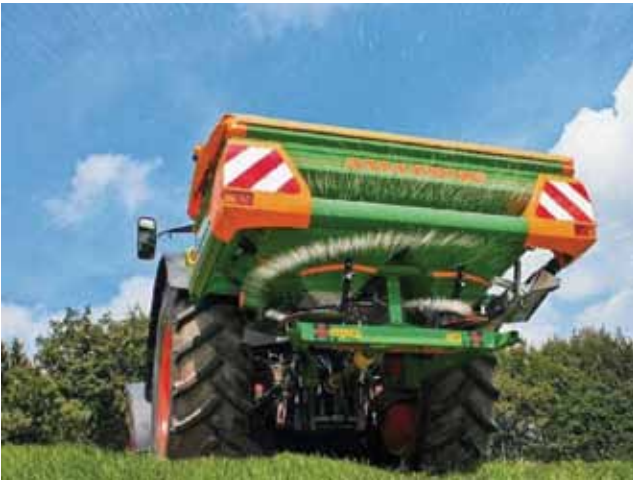
Joonis 2.10. Mineraalväetise ketaslaotur väetist laotamas (Amazone, 2011)
