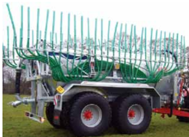
Joonis 5.40. Ülespööratud lohisvoolikud (Briri, 2009)
