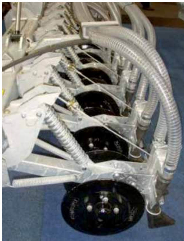
Joonis 5.17. 1-kettaline avalõhe-sisestusseadis (Vettik, R.)
