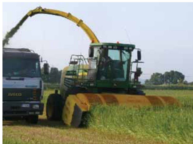
Joonis 8.6. Haljasmassi otsekoristus silokombainiga (Zürn, 2013)
