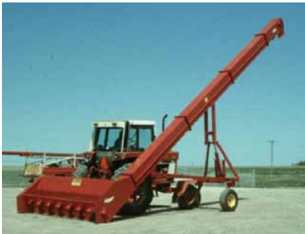
Joonis 2.4. Konveierlaadur (Iowa, 2007)
