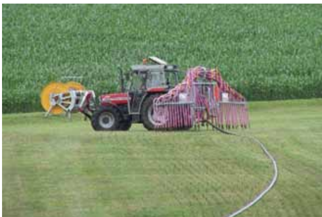
Joonis 5.47. Ripp-vooliklaotur (Vacutec, 2012)
