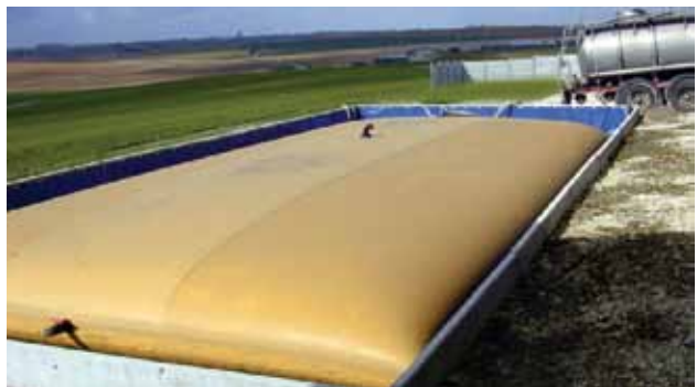
Joonis 3.2. Padjakujuline kottmahuti vedelväetiste hoiustamiseks (Excon, 2013)
