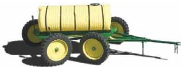
Joonis 3.4. Pööratavate sildadega paakhaagis (Redball, 2011)
