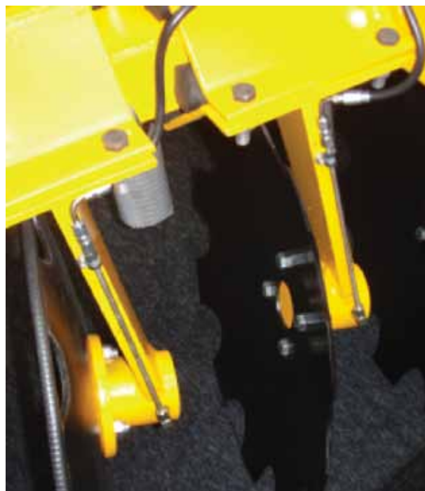
Joonis 5.41. Sundmäärimisega kettalaagrid (Vettik, R.)
