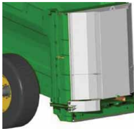
Joonis 4.22. Laotamiseseadme kate ja küljepiiraja (Joskin, 2011)
