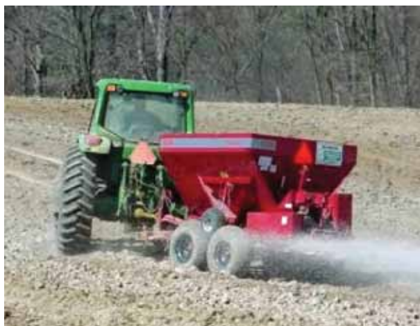
Joonis 7.7. Nõrgalt tolmja meliorandi laotamine punkri ja ketaslaotamisseadmega laoturiga (Monroeswcd, 2012)
