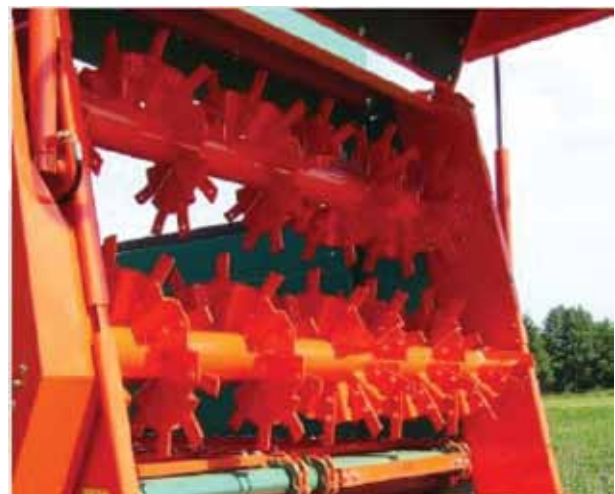
Joonis 4.15. Rõhtbiitriga tahalaotamiseade, biitrite all on näha kaks kitsast etteandekonveierit (Briri, 2012)
