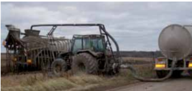
Joonis 5.11. Ümberpumpamine eraldi traktorile paigaldatud pumpamissüsteemiga (Vettik, R.)
