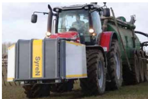
Joonis 5.3. Laotamisaeagseks happe lisamiseks on traktori esiripp-süsteemile kinnitatud kolm paaki: vasakul hele paak raudsulfaadi, keskel suurem paak väävelhappe ja paremal teine hele paak loputusvee jaoks (Agrotech, 2012)
