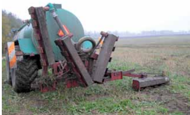
Joonis 5.24. Survelaotur, parempoolne laotusseadis on tööasendis ja ülejäänud kolm transpordiasendis tööasendis (Vettik, R.)
