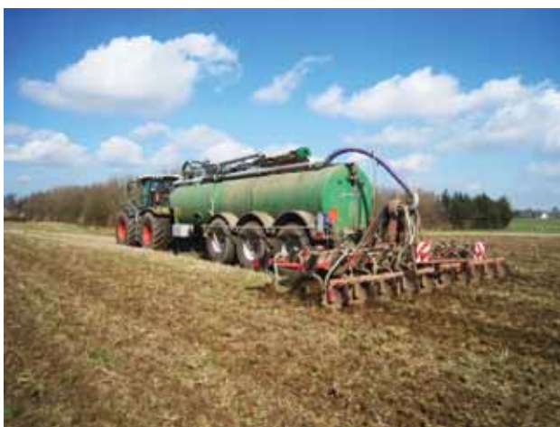
Joonis 6.2 Poolvedela sõnniku laotamine kombineerituna rapsi külviga (Stroco Agro, 2012)
