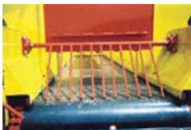
Joonis 7.4 Lintkonveier laoturi väetisepunkri põhjas (Hufgard, 2012)
