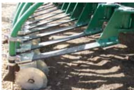
Joonis 5.27. Töösügavuse tagamine lehtvedrudega (Vettik, R.) Joonis 5.28. Hüdrauliline töösügavuse hoidmine (Vettik, R.)
