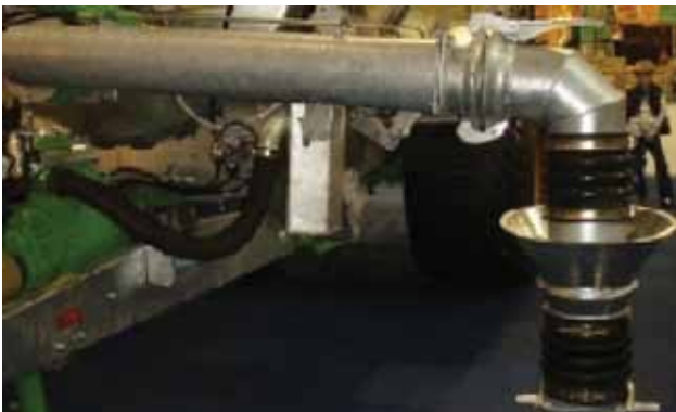
Joonis 5.34. Hüdrauliliselt liigutatav tankimisseadis (Vettik, R.)
