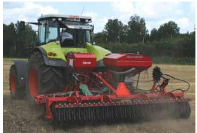
Joonis 2.17. Põimagregaat samaaegselt mullaharimiseks, peenseemne külviks ja väetise laotamiseks (Tamm, K.)
