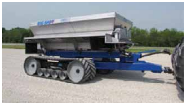
Joonis 2.18. Roomikutel laotur mineraal- või lubiväetise laotamiseks (Doyle, 2012)
