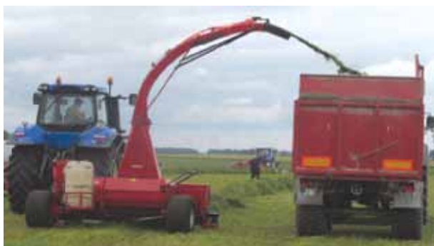
Joonis 8.8. Haakehekseldiga haljasmassi vaalust kogumine ja haagisele hekseldamine (Vettik, R.)
