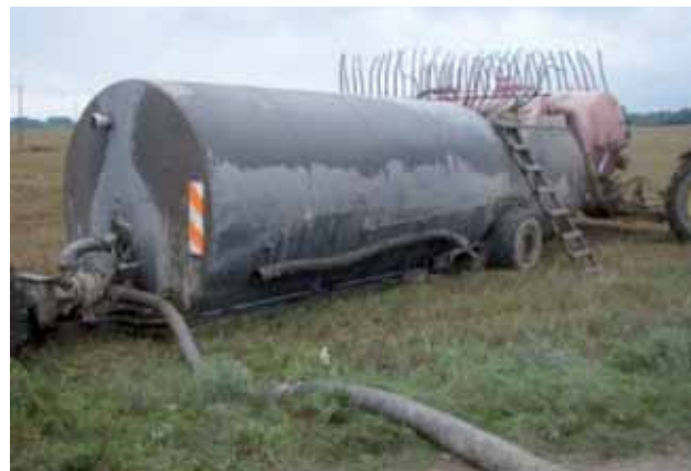
Joonis 5.10. Teisaldatav pumbaga vahemahuti. Taustal transpordiasendis lohisvoolikutega laotur pumpab vahemahutist vedelsõnnikut oma paaki. Esiplaanil oleva vooliku kaudu pumpatakse veoki paagist vedelsõnnik vahemahutisse (Vettik, R.)
