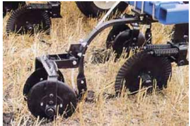
Joonis 3.17. Ammoniaagi muldaviimise seade, liikumissuunaga vasakult paremale. Tagumise kettapaari ees on vedelväetise voolik (AgSystems, 2011)
