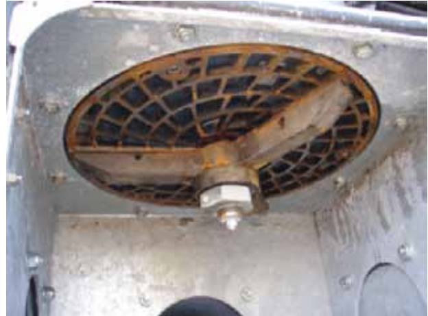
Joonis 5.35. Peenesti-võõrkehaemaldi (Vettik, R.)
