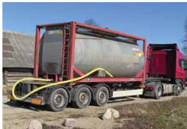
Joonis 3.5. Paakauto vedelväetise veoks (Tamm, K.)
