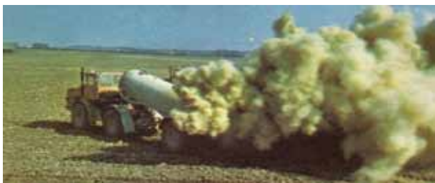
Joonis 7.3. Paakmahuti ja düüs-laotamisseadmega pneumolaotur tolmjate lubiväetiste laotamiseks (Tuhalaotus, 2012)
