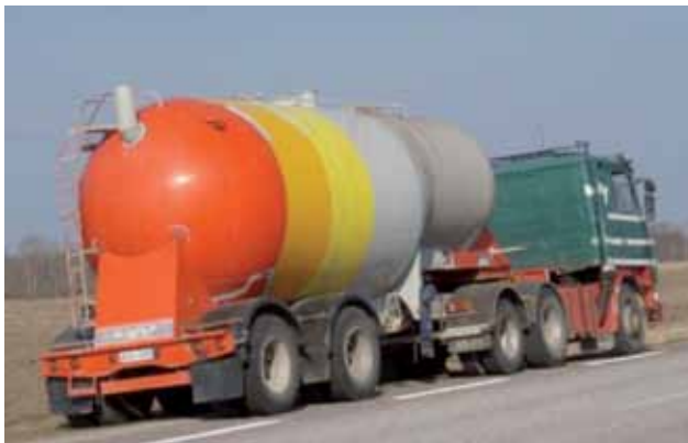
Joonis 5.9. Paakpoolhaagis vedelsõnniku etteveoks (Vettik, R.)
