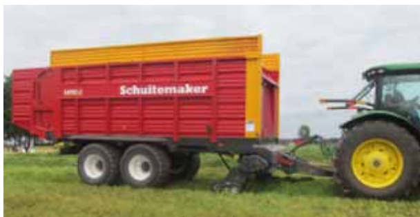
Joonis 8.9. Haljasmassi vaalust kogumine kogurkäruga (Vettik, R.)
