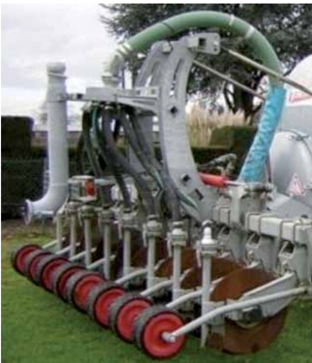
Joonis 5.20. Lõhed suletakse surverattaga (Pichon, 2012)
