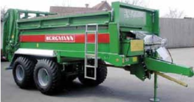
Joonis 4.9. Laoturi kasti esiosa ülemine osa on perforatsiooniga, et oleks võimalik traktorist jälgida kasti tühjenemist (Bergmann, 2012).
