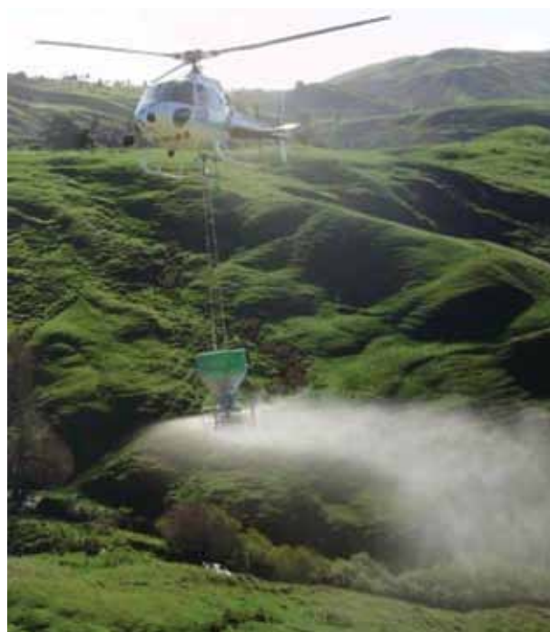
Joonis 7.10. Rohumaadele lubiväetise laotamine helikopteri rippüsteemile haagitud ketaslaoturiga (LimePlus, 2012)
