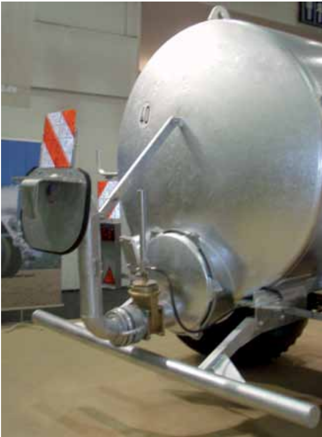
Joonis 5.13. Püstsuuriga paisklaotur (Vettik, R.)
