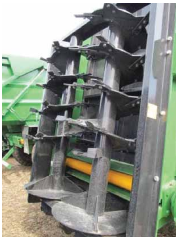
Joonis 4.18. Kahe püstbiitri ja ketastega tahalaotamise seade (R. Vettik)
