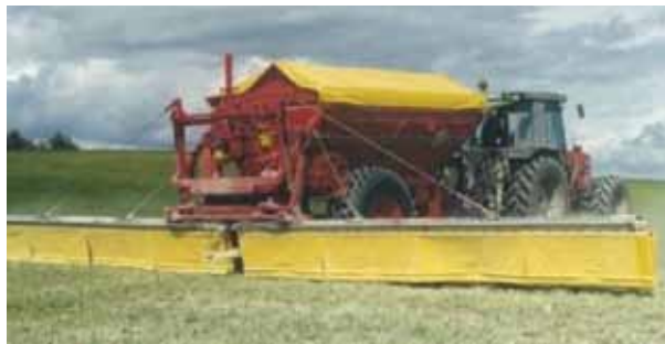
Joonis 7.6. Torupoom-laotamisseade on tolmjate lubiväetiste laotamisel varustatud tuulekardinatega (Bredal, 2012)
