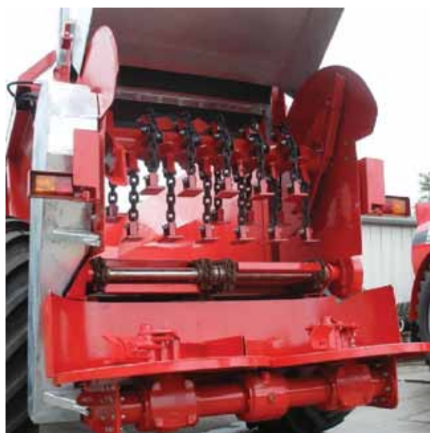
Joonis 4.19. Ühe rõhtse kootbiitri ja laotamisketastega tahalaotamise seade (HiSpec, 2012)
