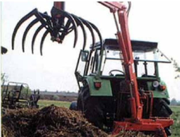
Joonis 4.3. Haaratsiga ekskavaatorlaadur (Vzorec Raka, 2012)
