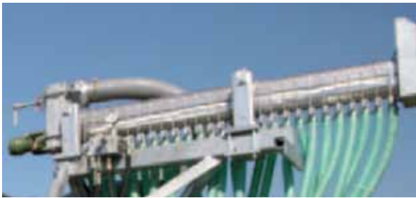
Joonis 5.33. Hüdmootoriga käitav tigukonveierjagur (Vettik, R.)
