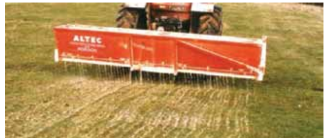
Joonis 2.16. Kastlaotur mineraalväetise ja lubja täpseks laotamiseks (Altec, 2012)
