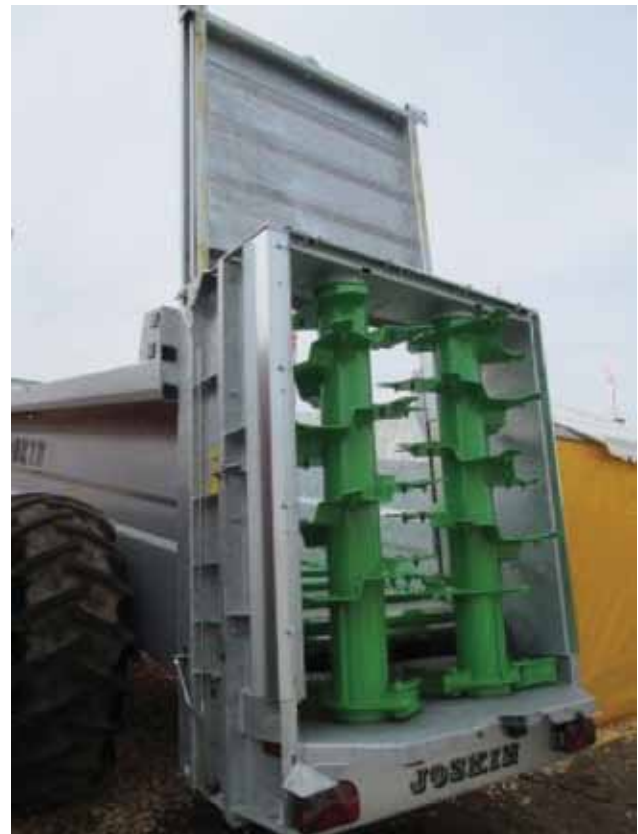
Joonis 4.14. Laotusseadmele etteantava sõnnikukihi kõrgust reguleeriv siiber, joonisel on maksimumkõrgusel (Vettik, R.)
