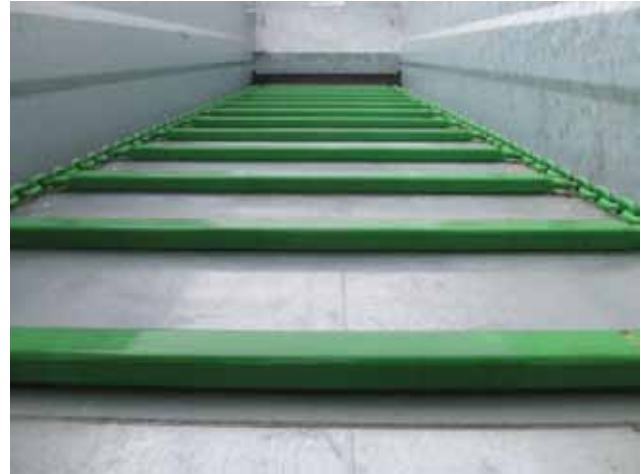
Joonis 4.10. Laoturi kasti põhjas olev kett-liistkonveier (Vettik, R.)
