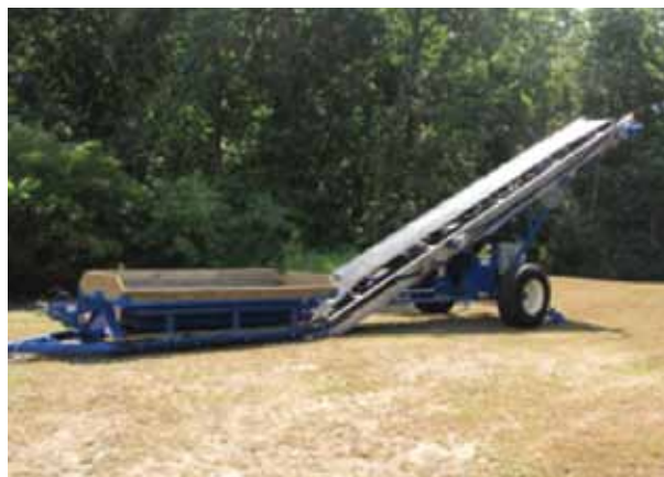
Joonis 7.2. Teisaldatav vastuvõtupunktri ja tõstekonveieriga laadur, ajamiks on diiselmootor (Doyle, 2012a)
