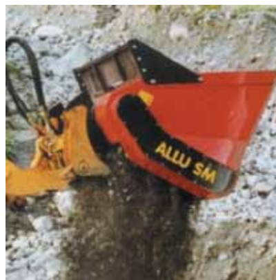
Joonis 7.1. Kopp-purustis on trummelfrees, mis peenestab kopas olevat materjali nii kaua kuni see freesi all olevast sõelast läbi variseb (Allu Group, 2013)
