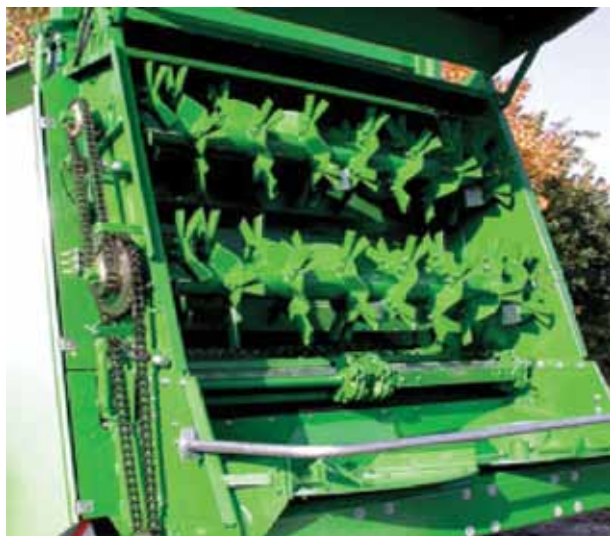
Joonis 4.16. Rõhtbiitrite ja laotamisketastega tahalaotamise seade (Bergmann, 2012)
