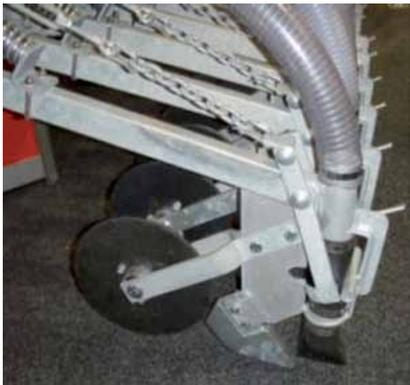
Joonis 5.19. 1-kettaline kiiluga avalõhe sisestusseadis (Vettik, R.)
