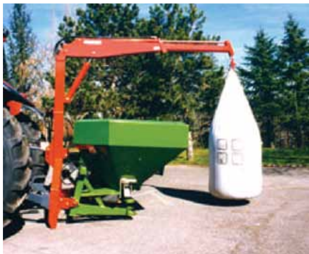
Joonis 2.7. Suurkottis oleva mineraalväetise transpordivahendilt laoturi kasti teisaldamiseks vajalik kraana võib olla paigaldatud koos laoturiga traktori rippüsteemile (Altec, 2009)
