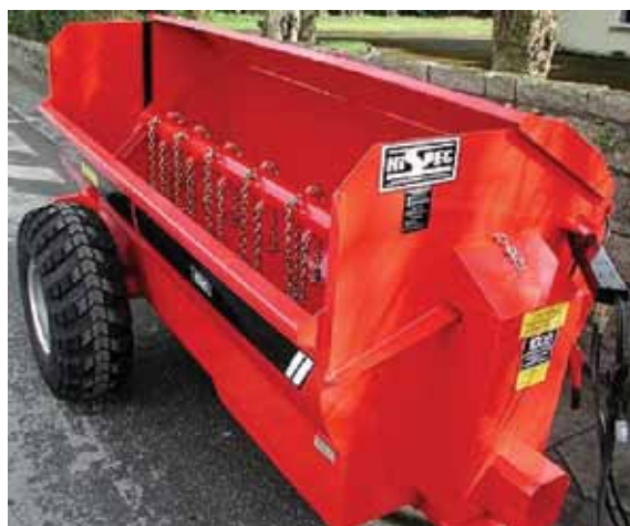
Joonis 4.26. Külglaoatamisega pikibiitriga kootlaotur. Antud mudelil on biitri telje kõrgus mahuti põhja suhtes samal kõrgusel (HiSpec, 2012)
