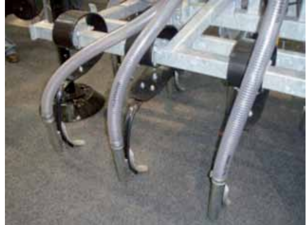
Joonis 5.21. Sügava muldaviimise kobestuskäpad (Vettik, R.)
