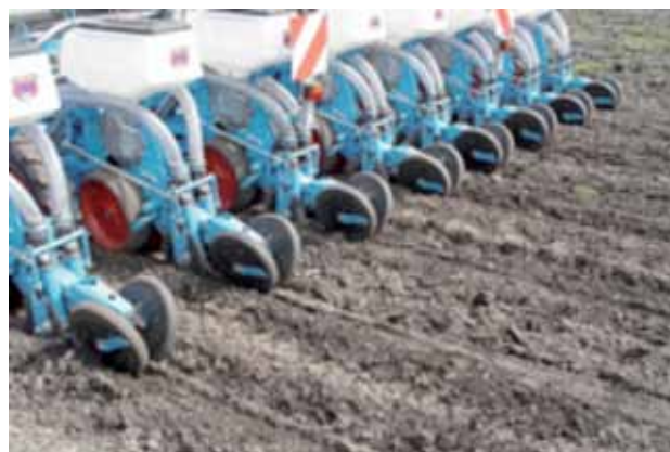
Joonis 5.26. Vedelsõnniku muldaviimine üheaegselt maisikülviga (Slootsmid, 2012)
