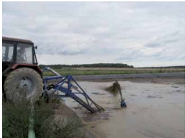
Joonis 5.6. Veise vedelsõnniku hüdrauliline segamine laguunis pumpseguriga (Tamm, K.)
