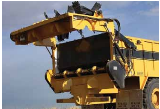
Joonis 4.6. Ülestõstetav laotusseade võimaldab laoturi kiiremat tühendamist (KSCC, 2012)
