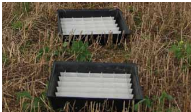
Joonis 2.19. Kogumispannid, mille abil määratakse väetise põikjaotumust (Freestone, 2011)
