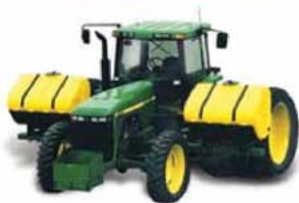
Joonis 3.13. Töökäigule kaasavõetava vedelväetise koguse suurendamiseks kasutatakse ka esi- ja külgmahuteid (Redball, 2011)
