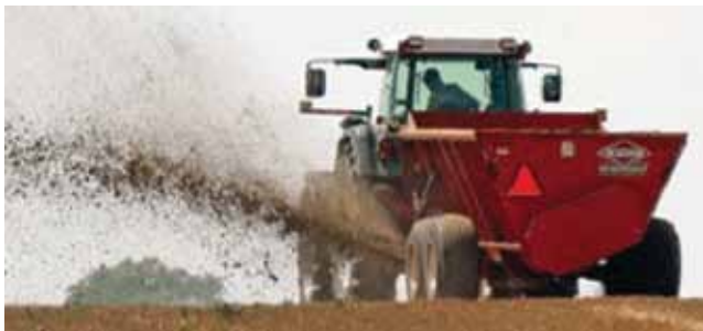
Joonis 4.24. Külglaoatamise ja punkermahutiga tahesõnnikulaotur (Kuhn, 2012)
