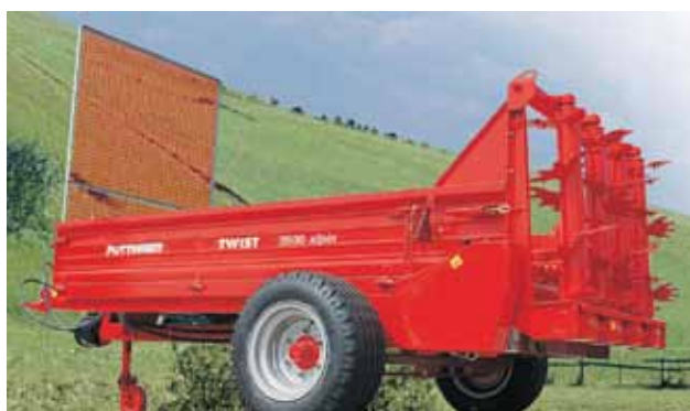
Joonis 4.17 Nelja püstbiitriga tahesõnniku laotur (Pöttinger, 2012)
