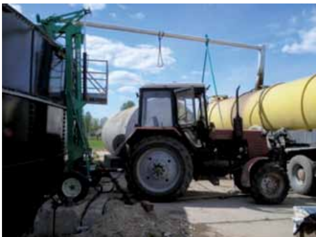
Joonis 5.7. Traktorilt käitav pumpsegur vedelsõnniku hoidlast paakautosse pumpamiseks (Vettik, R.)
