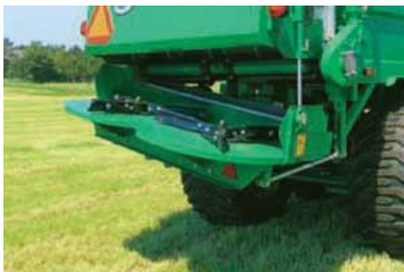
Joonis 4.20. Kui ketaslaotamiseseade on kallutatud, siis on madalamal küljel laotamiskaugus väiksem kui kõrgemal küljel (Samson, 2010b)
