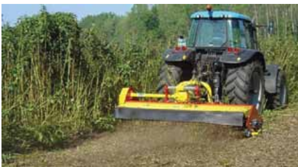
Joonis 8.5. Haljasmassi niitmine trummelniidukiga (INO, 2012)
