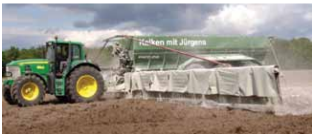
Joonis 7.8. Mahuti ees paikneva torupoom-laotamiseseadmega laotamisagregaat (Fortuna, 2012)
