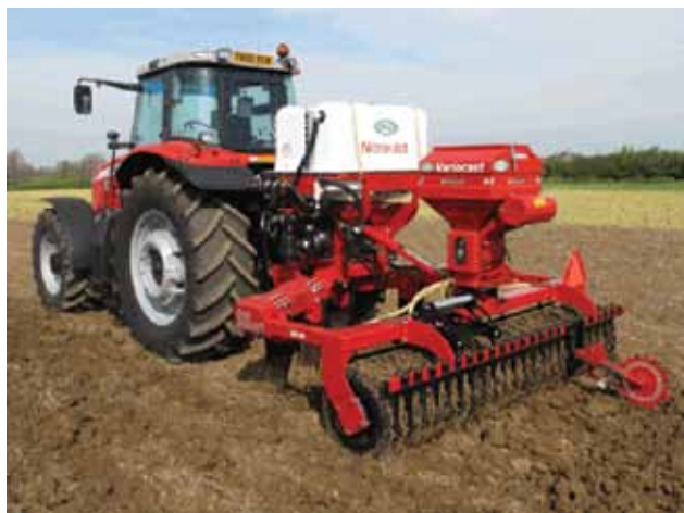
Joonis 3.11. Vedelväetamine koos sügavkobestamise ja rapsi külviaga (Graematic, 2011)
