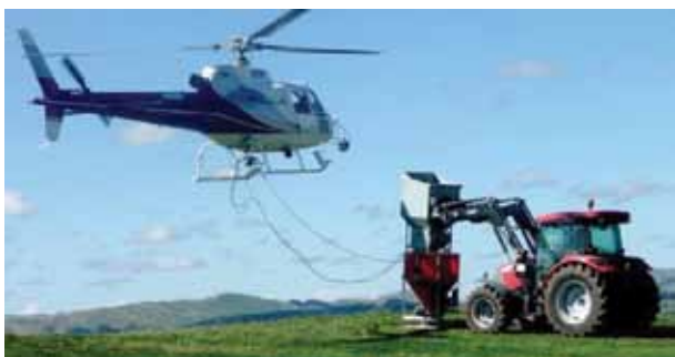
Joonis 7.9. Helikopteri külge haagitud ketaslaoturi punkrisse lubiväetise laadimine kopp-purusti abil (LimePlus, 2012)
