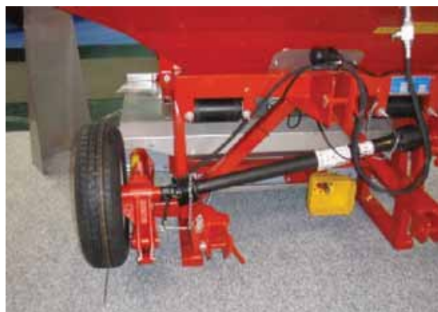
Joonis 2.8. Väetiselaoturi annusti mehaaniline ajam käigurattalt (Vettik, R.)
