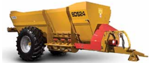
Joonis 6.3. Külgväljutuse ja punkermahutiga rootorlaotur sobib ka poolvedela sõnniku laotamiseks. Laoturi ratta ees on näha välimine osa laotamisseadisest (Richard Western, 2012)
