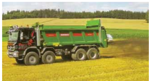
Joonis 4.7. Tahesõnnikulaotur on monteeritud veoautole (Bergmann, 2012)
