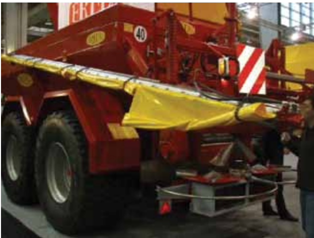
Joonis 2.15. Vahetatava laotamiseadmega väetiselauturil saab vahetada ketsaadme torupoom-seadme vastu (Vettik, R.)
