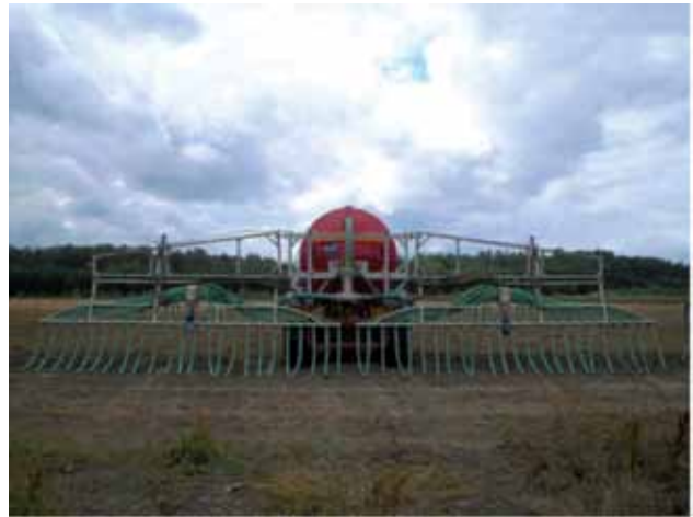
Joonis 5.14. Lohislaotur tagantvaates (Vettik, R.)
