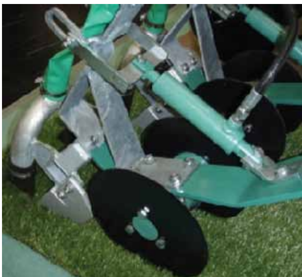
Joonis 5.39. Voolikute hüdroksulgur (Vettik, R.)
