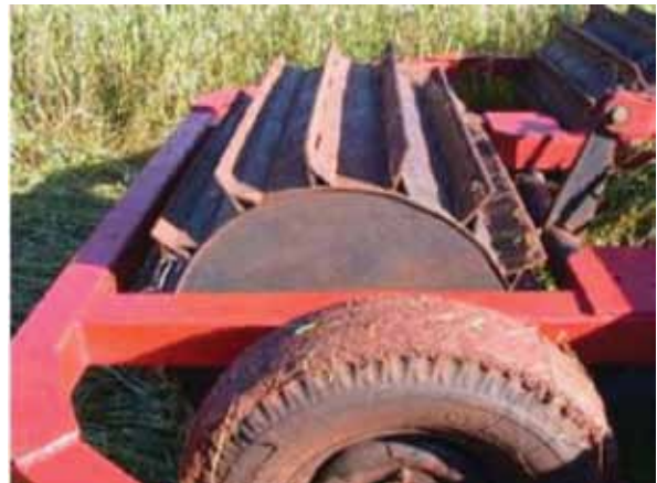
Joonis 8.2. Sirgete ribidega rull haljasväetiskultuuri taimiku maharullimiseks (Derpsch, 2012)
