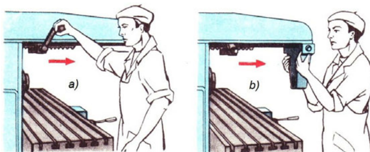
Joonis 3.2.4.8. Ülatala nihutamine ja ripplaagri lahtivõtmine; a) nihutamine, b) ripplaagri eemaldamine
