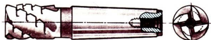
Joonis 3.2.7.7. Muutuva ringsammuga teravatipuliste hammastega sõrmfrees
