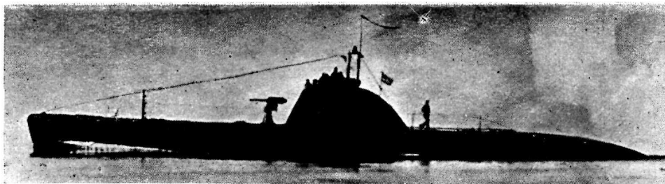
N. Vene „M“ tüüpi 200-t. a-laev; kiirus \frac{15}{8} s; relvastus 1–37 mm suurt. ja 2 torpeedotoru
