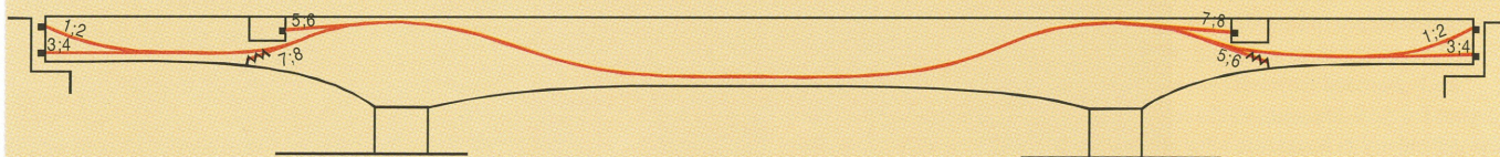
Kärevere silla eelpingetrosside paigutuse skeem.
