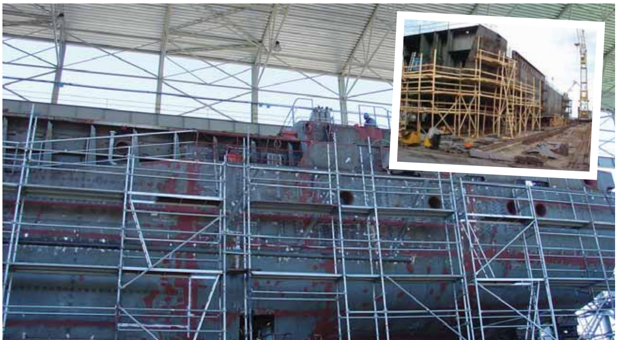
Veel mõni aeg tagasi ehitati laevu puust tellingutel lageda taeva all. Nüüd on olemas varikatused ja korralikult kinnitatavad kaasaegsed alumiiniumtellingud.
