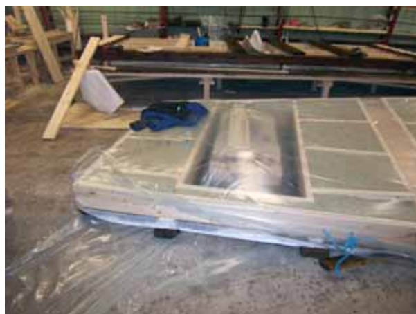
Alusele ebastabiilselt asetatud seinaelement kukkus töötajale peale, kui töötaja püüdis eemaldada elemendi alla kinni jäänud kilet. Fotod: Kalmer Kärblane
