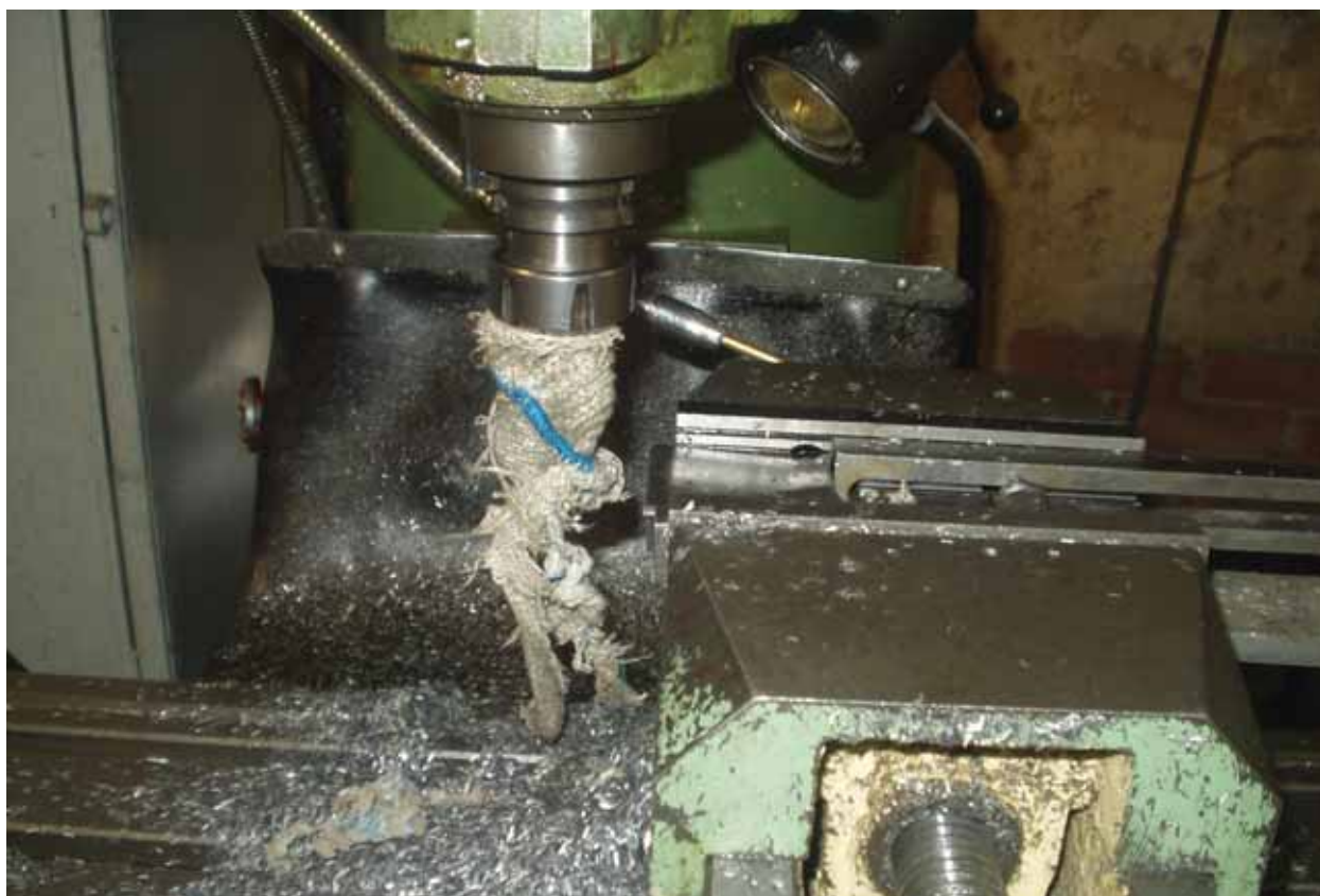
Töötaja vasakus käes olnud kinnas jäi inertsiist pöörleva freesitera külge kinni. Masina freesitera töötsoon oli täielikult avatud, seiskamiseks pidi töötaja kummarduma, puudus avariinupp. Foto: Kalmer Kärblane
