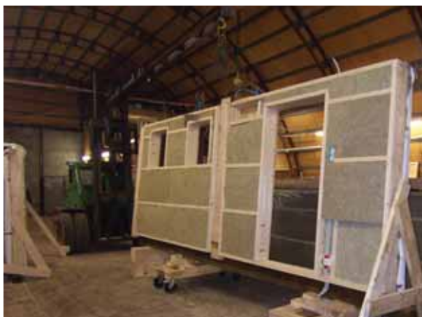
Alusele ebastabiilselt asetatud seinaelement kukkus töötajale peale, kui töötaja püüdis eemaldada elemendi alla kinni jäänud kilet. Fotod: Kalmer Kärblane
