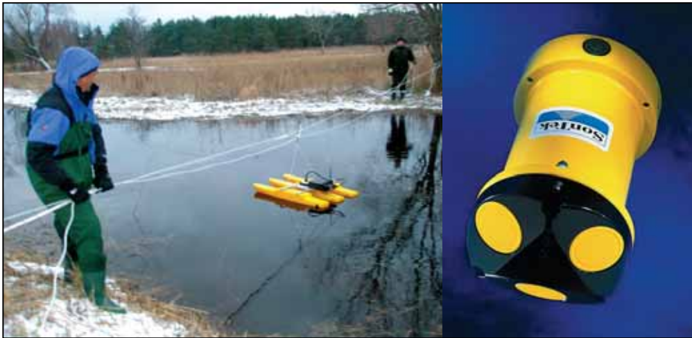
JOONIS 2. VOOLUHULGA MÄÄRAMINE TRIMARAAN-UJUKILE KINNITATUD MÖÖTURI ABL
