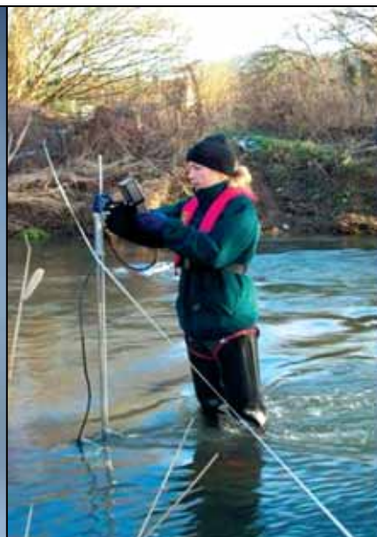
JOONIS 2. VOOLUHULGA MÄÄRAMINE TRIMARAAN-UJUKILE KINNITATUD MÖÖTURI ABL
