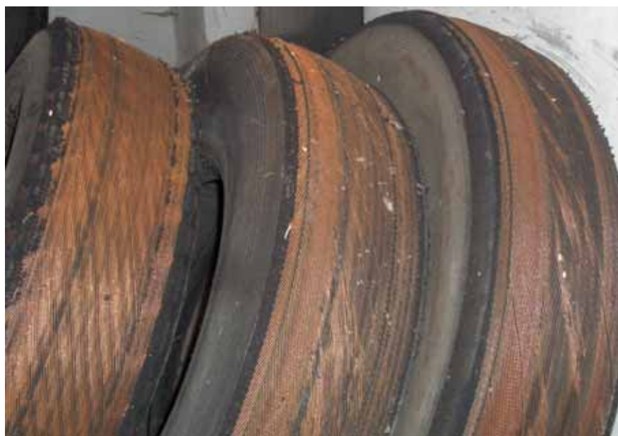
Joonis 4. Rehvidelt on pealmine kummikiht maha kooritud
