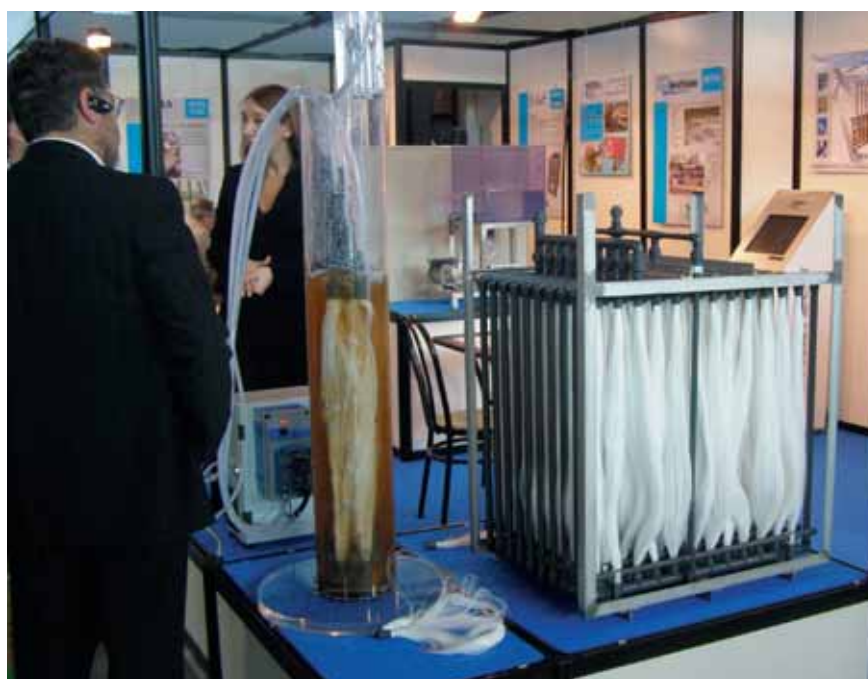
Joonis 5. Reo- või joogiveekäitluseks mõeldud painduvad membraan- (ultrafiltratsioon- või pöördosmoos-)voolikud. Tänu liikuvusele ei ummistu voolikute pind kinnipeetud ainetega
