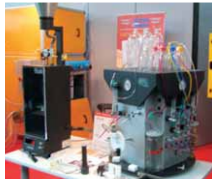
Joonis 2. Tindiprinteri värvikassettide uuendamise seade. Kassett pestakse, selle käsna vahetatakse ning kassett täidetakse uue trükivedelikuga
