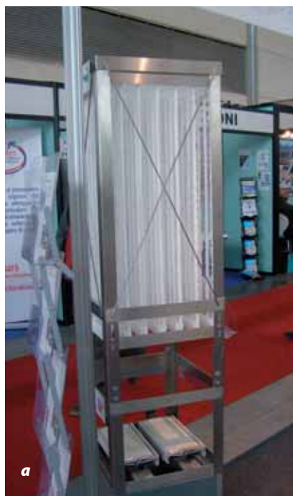
Joonis 3. Õhustatavate biofiltrite uudne täitematerjal Saksamaa firmalt Cleartec Water Management GmbH : a tekstiil-biokilekandja moodul (alumisel korrusel paistavad peenmullõhustid), b biokile kinnitub roostevabale raamile pingutatud sünteetilise kanga külge
