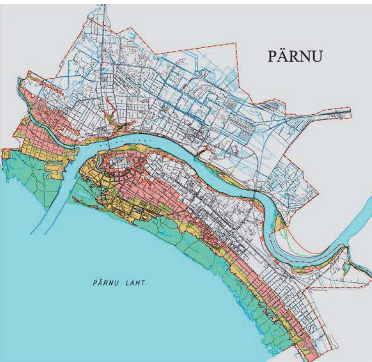
Joonis 6. Üleujutatava ala muutumine Pärnus ja Tallinnas (Kakumäel), kui merevesi tõuseb praeguse kriitiliselt tasemelt 1,5 m abs (roheline ala) tasemeni 2,5 m abs, s.o ühe meetri võrra (kollane ala). Punaseks on värvitud kõrge veetaseme mõjutatav ala meetrise meretõusu korral
