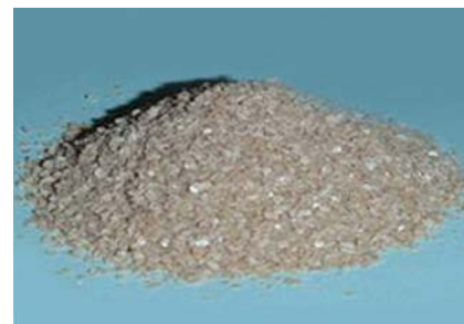
Fosfaatide ärstamisel reoveest NuReSys ® -tehnoloogia kohaselt moodustub kristalliline struvite
