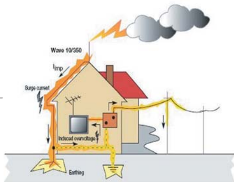
Joonis 2. Otsesiselöök piksevardasse: piksevool suundub küll maandurisse, kuid pinnase takistuse tõttu maapinna potentsiaal tõuseb ja halvimal juhul võib kuni 50% energiast toitevõrku üle kanduda.
