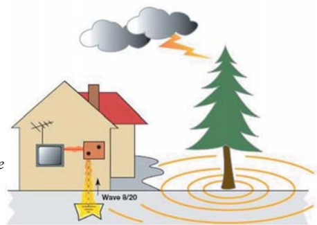
Joonis 3. Sisselöök hoone lähikümb- ruse: sarnaselt eelmise juhtumiga tõuseb maapinna potentsiaal ja hoone maanduri kaudu kandub osa energiast üle toitevõrku.
