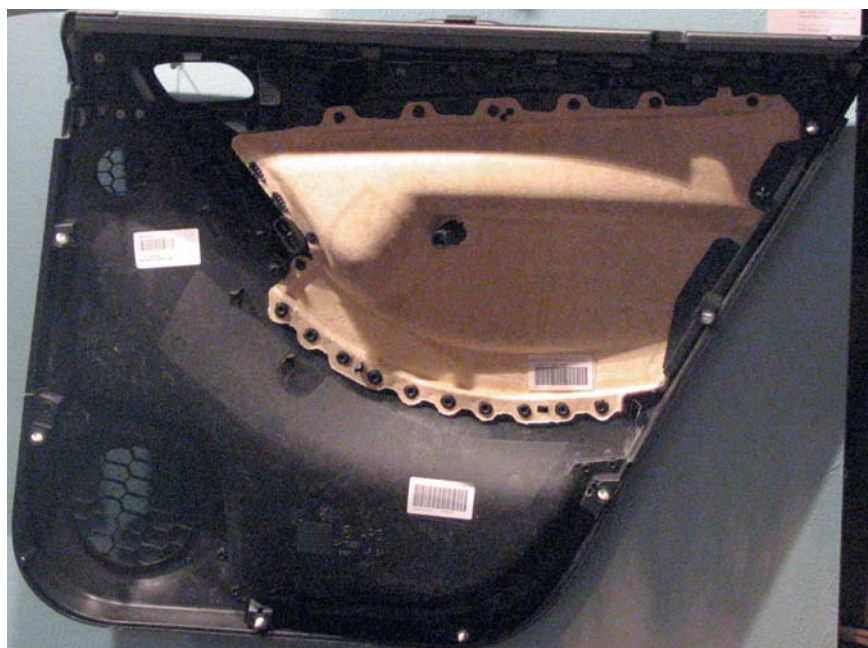
Joonis 7. Lühikestest linakiududest ja PP-st survevalu teel valmistatud uksepolstri kate
