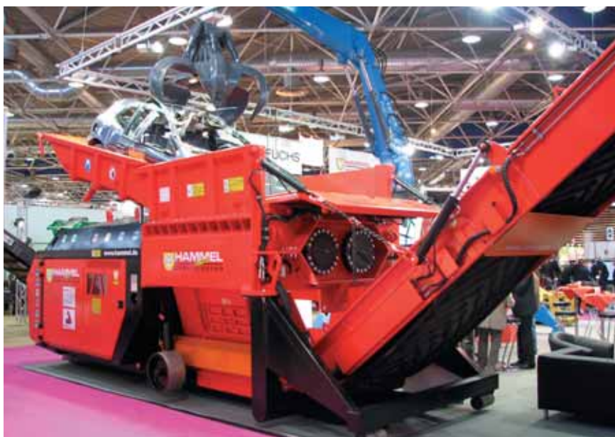
Joonis 4. Firma Hammel mobiilne purustusseade
