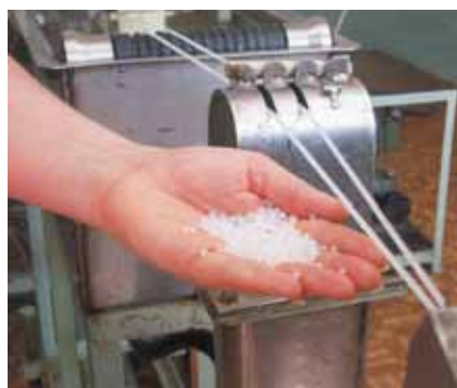
Joonis 4. Polükoarbonaatmaterjalide jäätmetest toodetud polümeersest komposiitmaterjali saab kasutada nt auto- ja elektroonikatööstuses ning elektrimaterjalide tootmisel
