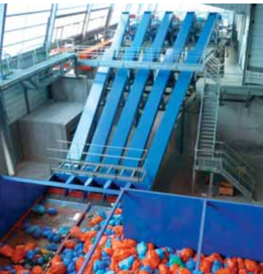
Joonis 3. Optiline jäätmekotisorter Bagtronic [4]
