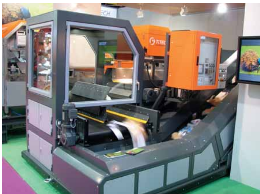
Joonis 1. Plast- ja tetrapakendite lahusortimisseade
