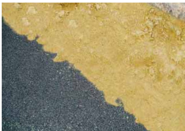
Joonis 8. Vanarehvide purustamisel saadavast kummipurust valmistatakse jalgpalliväljakute elastseid aluspõhju
