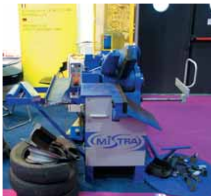
Joonis 5. Metalljäätmete tükeldamisgiljotiin Mistra
