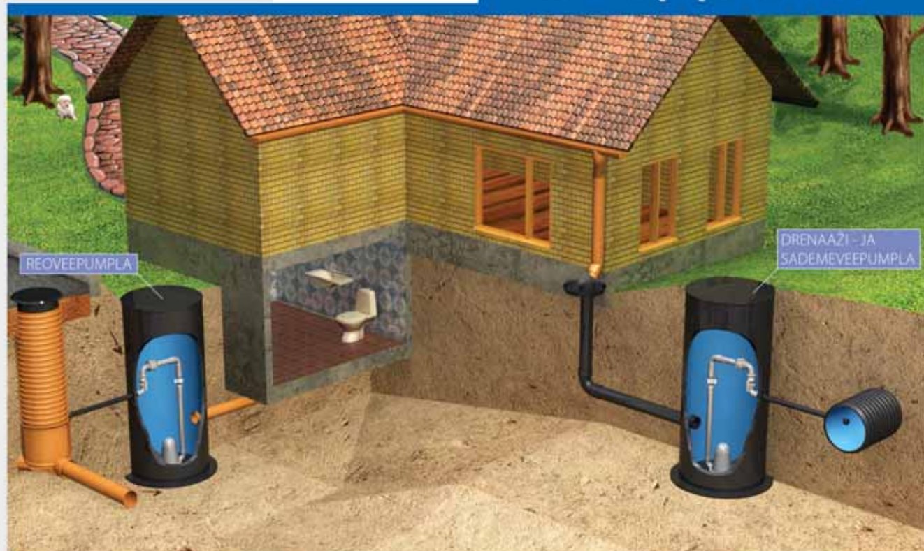
Joonis 1. Eramaja reovee- (vasakul) ning sademe- ja dreneaživeepumpla
