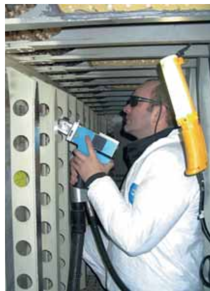
Mobiilse laseri CL 1000 abil saab puhastada mitmesuguseid pindu
