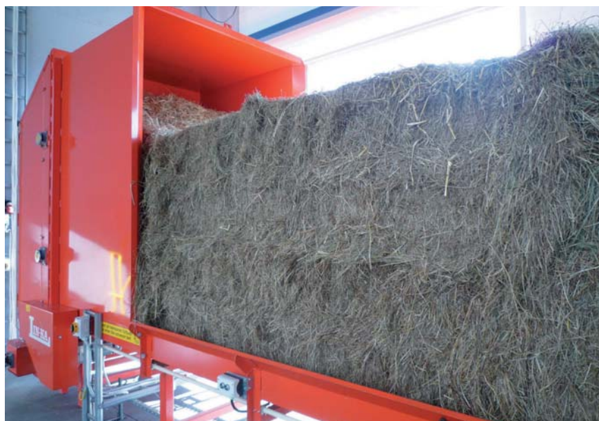
Kütuse etteande- ja peenustusliin
