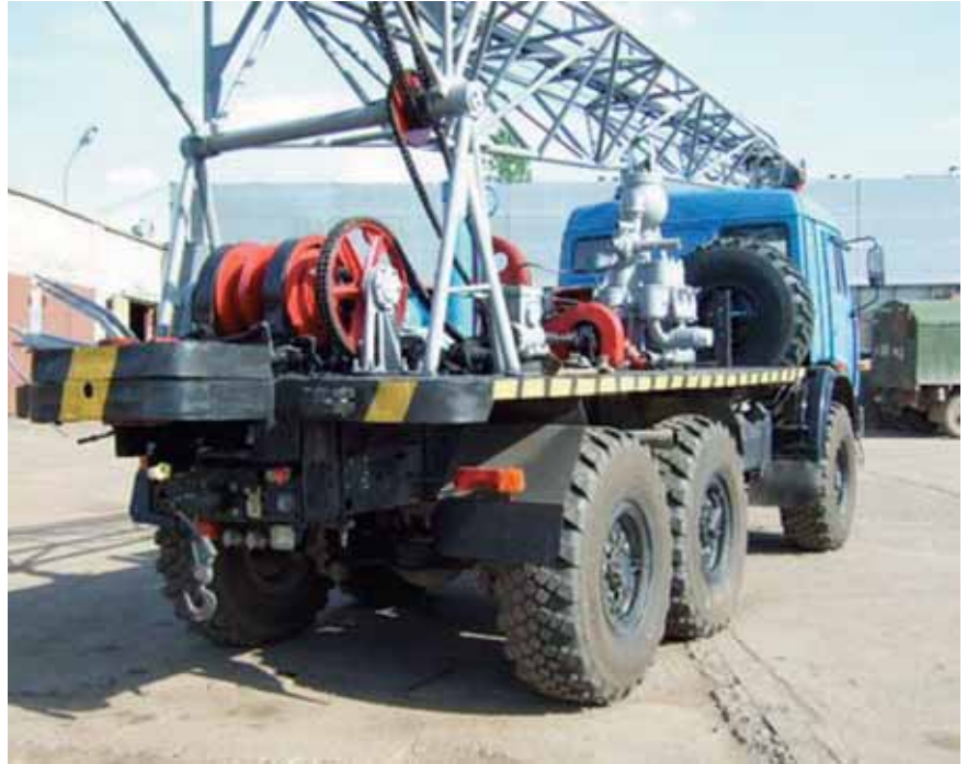
Joonis 1. Jäigalt kinnitatud rootoriga nõukogude päritolu puurmasin YP5 2,5 A ( http://www.burovoportal.ru/burov/images/kap_remontnaya_urb_2_5a_010.jpg )
