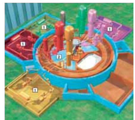
Joonis 2. Tuumareaktor EPR: 1 on jahutus- ja turvasüsteemid ning 2 reaktor Allikas: EPR, Areva, 2005
