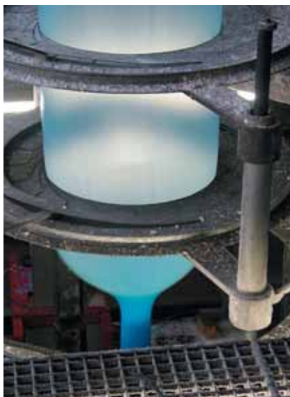
Polüetüleenkile valmistamine puhumismeetodil
