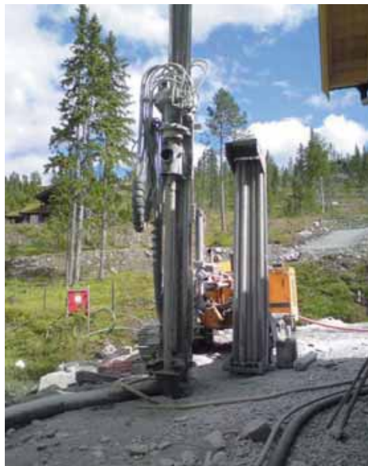
Joonis 3. Ühe rootoriga puurmasin NEMEK
