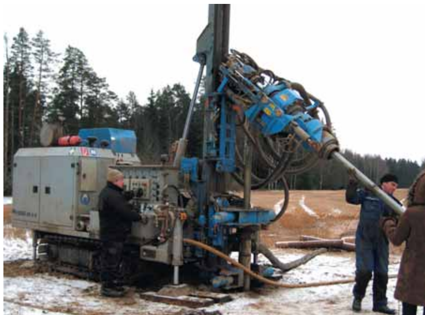
Joonis 5. Kahe rootoriga puurmasin Bauer RB8R, mille rootoreid on võimalik kaldu tõsta, et puurvardaid saaks mugavalt ja kiiresti vahetada Foto: A. Marandi
