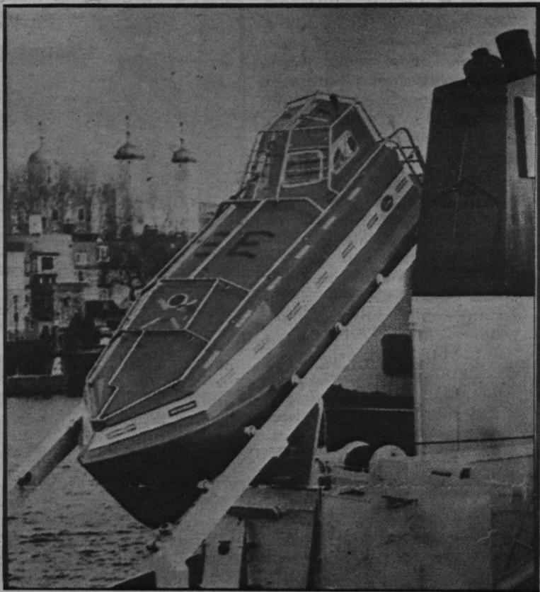
Tavaliste paaditaavetite aeg on möödumas. Uudse konstruktsiooniga päästepaat ja selle veeskamise seade. Eksponaat ohutu meresõidu alaselts näituselt SASMEX'90 (Safety at Sea & Marine Electronics), mis toimus Londonis 24.–26. aprillini 1990.
