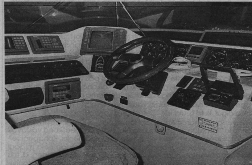
Messi ühe kallima "Sea Ray" kaatri kaptenisild on hästi ja (lolli)kindlalt varustatud. Elektronkaart, radar ja autopiloot, selja taga pudelialustega laud valge nahkdiivani ees, kraanikauss ja külmkapp. Jäämasin on tekk allpool.
