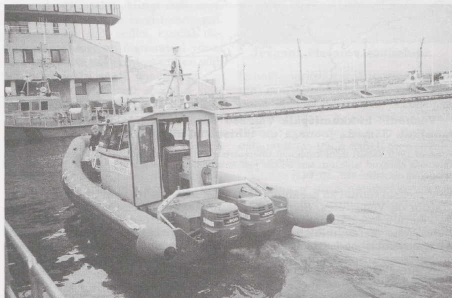
Uuel mootorpaadil on küttega roolimaja ja kaks rippmootorit ...
