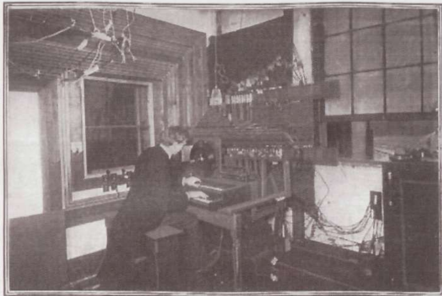
Ürgelektronika – telharmoonium, sündinud 19. sajandi lõpul. Tol ajal loodeti, et selline tehnikaiame nagu telefon hakkab peale kõnede edastama ka näiteks telharmooniumi tuutu-piiksu-kontserte.
