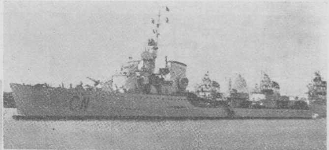
Hollandi taskuristleja „Tromp“. Veeväljasurve 3 350 t; relvast's 6 — 5,9" suurt., 4 — 40-mm õk-cut., 4 — 12,7-mm õk-k. ja 6 — 21" torp.-toru. Kiirus 32,5 s.
