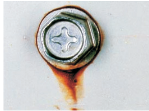
Korrodeerunud modifitseeritud martensiit roostevaba teras
