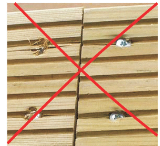
Kinnitamisel vigastatud laud või tsingitud kinnitustarvik rikub kogu kalli terrassilaua
