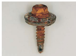
Korrodeerunud nitriiditud roostevaba teras
