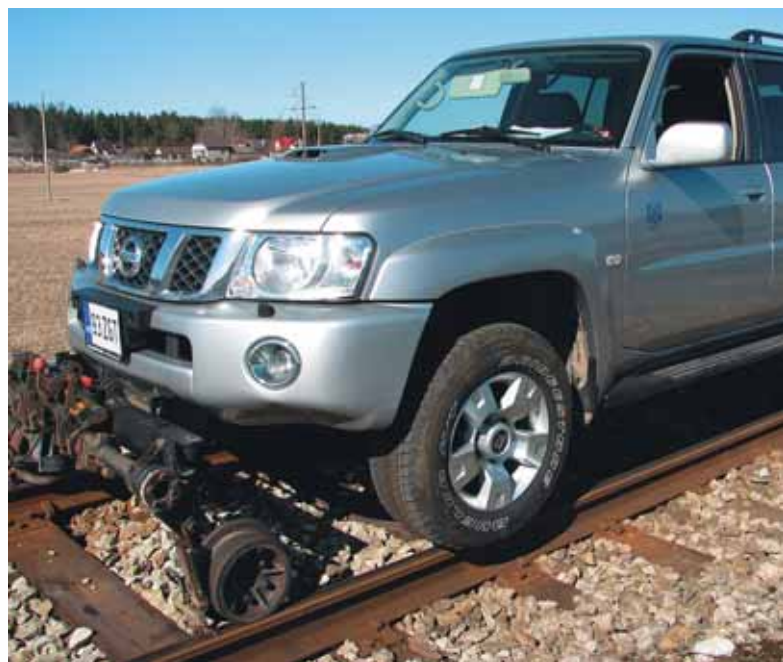
Tehnilise Järelevalve Ameti raudteeinfrastruktuuri kontrollivahend High-Rail sõiduk
