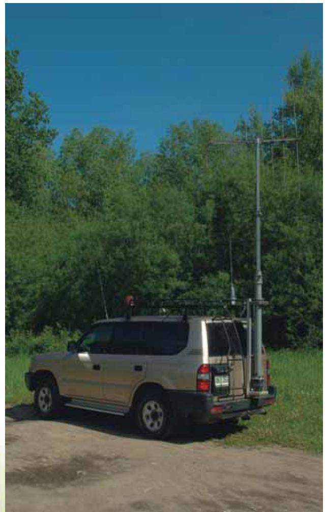
Raadiohäirete avastamiseks ja monitooringuks kasutatav liikuv mõõtejaam
