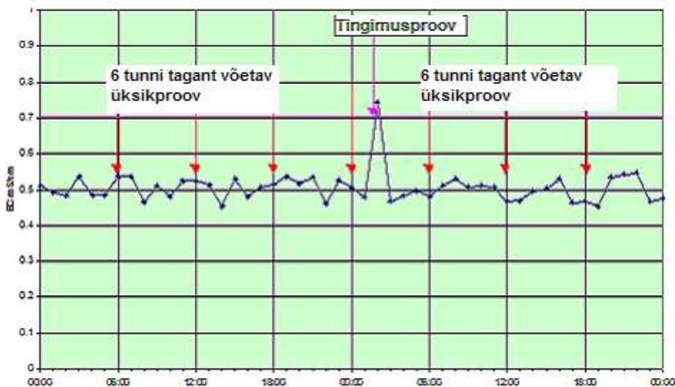
Joonis 2.1. Üksikproovide (osaproovide) võtmine kuue tunni tagant ajakeskmise proovi saamiseks ning tingimusproovi võtmine siis, kui olukord seda nõudis (elektrijuhtivus ületas piirväärtuse 0,7 mS/cm)
