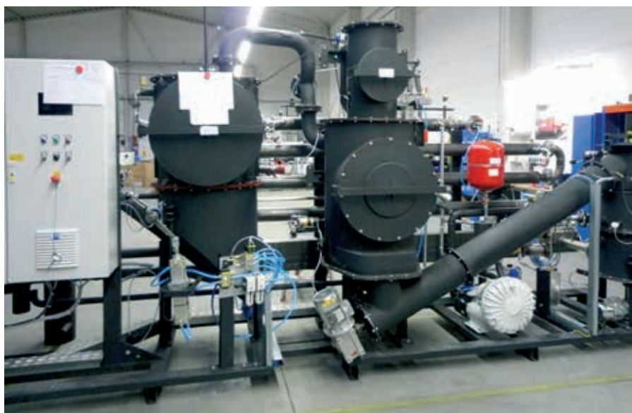
Joonis 3. Spanner Re 2 puugaasisti. Spanner Re 2 wood gasifier.
