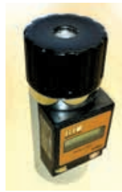
Niiskusemõõtja WILE biomassi niiskuse ekspresshindamiseks.
