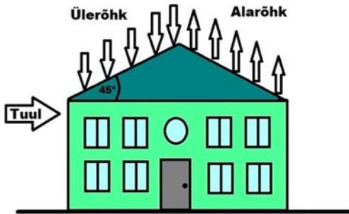
Joonis 22. Ala- ja ülerõhulised tsoonid katusel kaldega 45°
