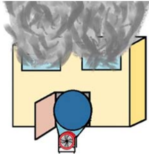
Joonis 34. Suundrõhuline suitsutuulutus (Hyttinen et al. 2014)
