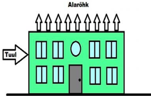
Joonis 24. Rõhutsoonid lamekatusel (Hyttinen et al. 2014)
