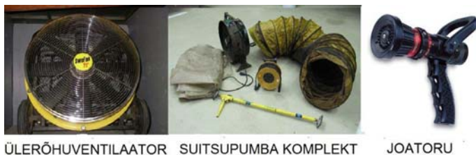
Joonis 31. Töövahendid mehaaniliseks suitsueemaldamiseks (autori foto)
