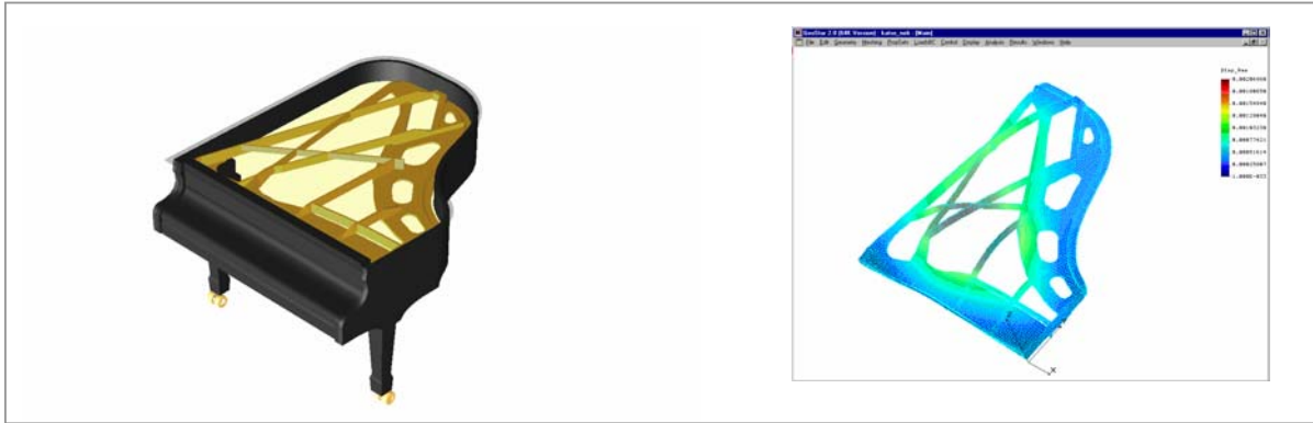
Joonis 5. Kabinetiklaveri 3D CAD mudel ja malmraami optimeerimise LEM mudel.
